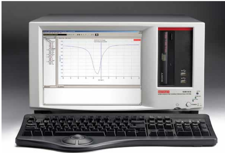
Resim 1.4. Kiethley marka 4200 SCS model yarı iletken karakterizasyon cihazı
