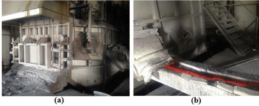
Şekil 5.6 : (a) Tutma fırını (b) ergitme ve tutma fırını arası metal iletimi.
