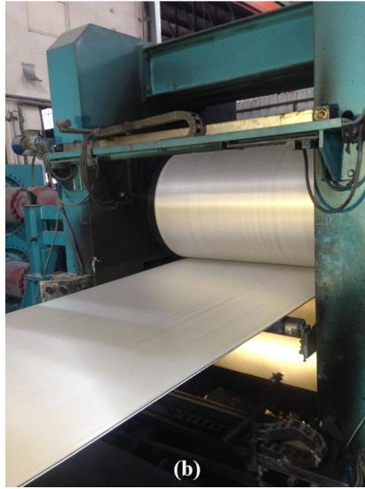
Şekil 5.11 : AA5754 alaşımı dökümü sırasında döküm makinası ve levhanın (a) uzaktan görünümü, (b) yakından görünümü ve (c) alttan görünümü.
