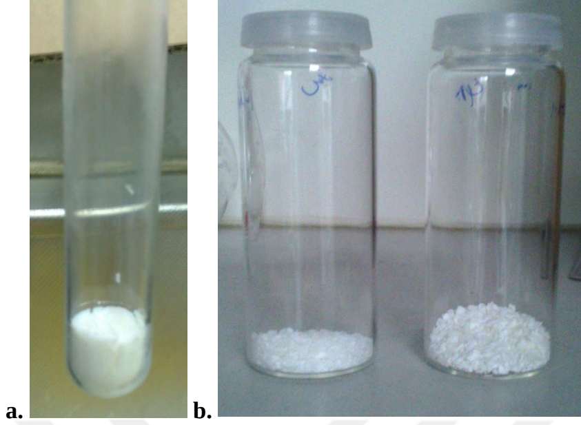
Şekil 4.2 Y4 MIP ve NIP a. Y4 MIP – polimerizasyon sonrası b. Sırasıyla, Y4 MIP ve NIP – yıkama işleminden sonra kullanıma hazır polimer.
