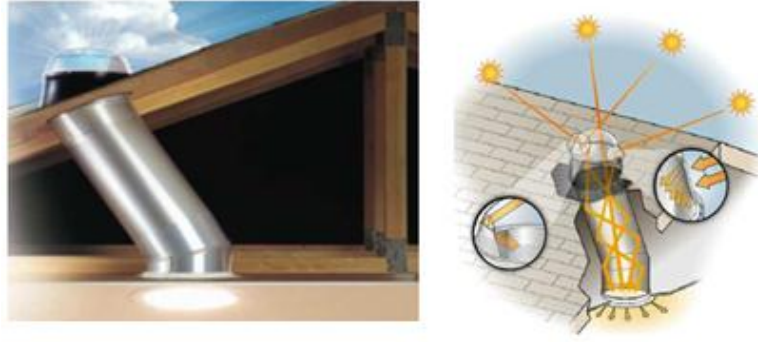
Şekil 57. Işık Tüplerinin Çalışma Prensibi (Okutan, 2008)
