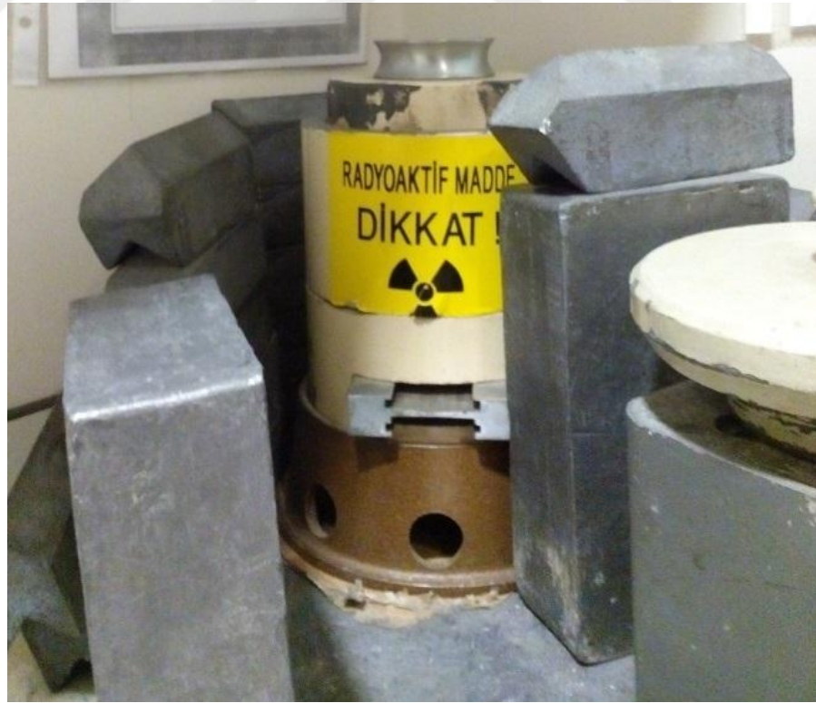
Şekil 3.16 28 yıl yarı ömre ve 590 MBq aktiviteye sahip ^{90}\text{Sr}/^{90}\text{Y} beta kaynağı.
