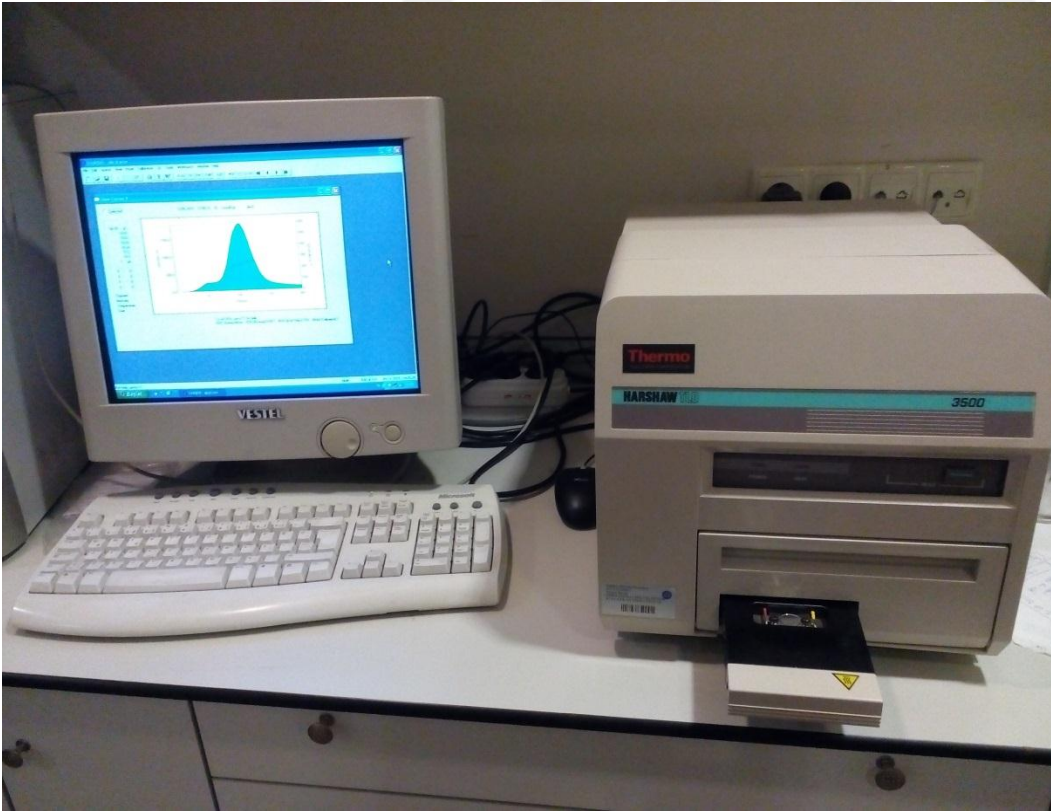
Şekil 3.11 TLD okuyucu sistemi (Harshaw marka Model 3500).
