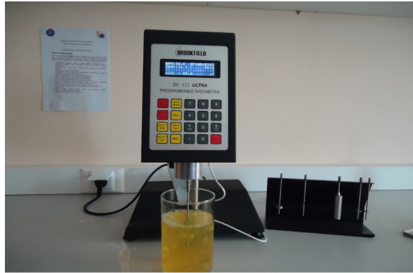
Şekil 3.8. Viskozimetre ile albümin viskozitesinin ölçülmesi
