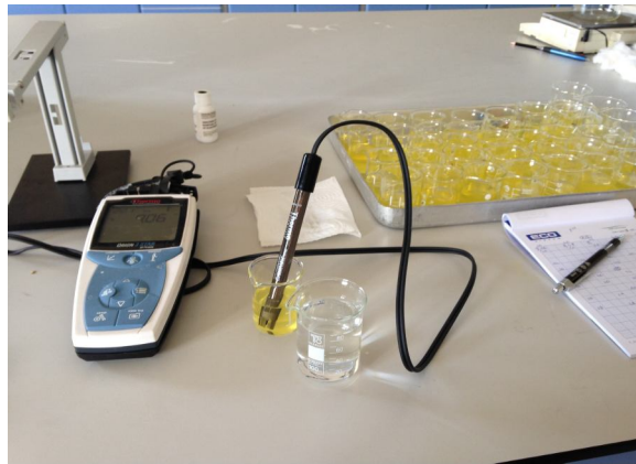
Şekil 3.6. pH metre ile yumurta albümin pH'sının ölçülmesi
