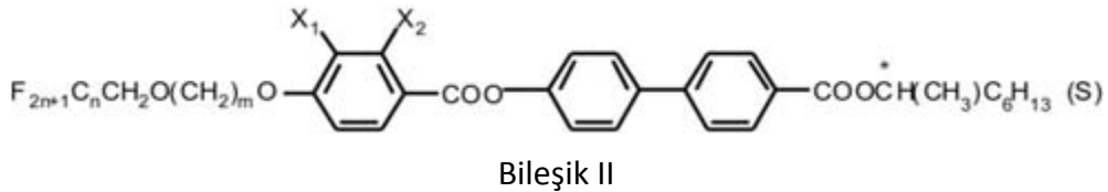
Şekil 3. 18 Perfloroalkanoiloksi alkoksi birimi içeren üç halkalı halojen substitüeli kiral ester yapısı [63].
