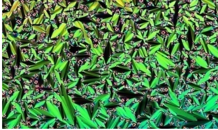
Şekil 5. 65 Bileşik 17a 'nın soğutma sırasında 113 °C'de çekilmiş SmA yelpaze tekstürü.
