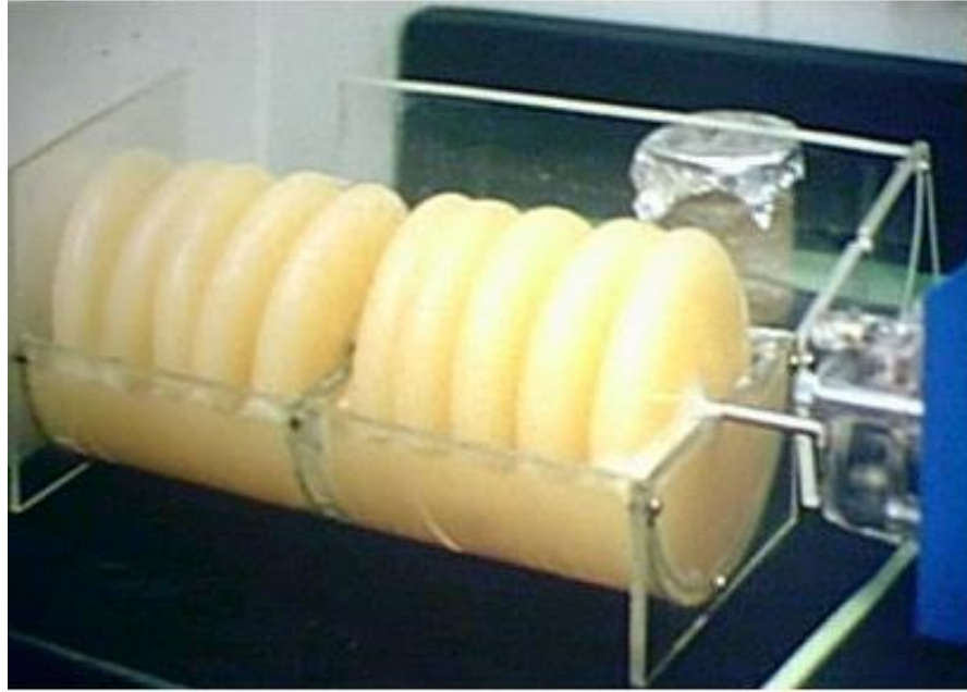
Şekil 2.11. Döner disk reaktörde üretilmiş bakteriyel selüloz [102]
