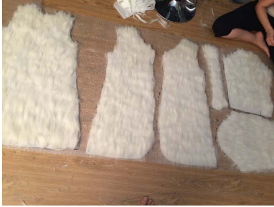
Resim 104: En üst katmana yünün eşit yoğunlukta ve daha yoğun şekilde yerleştirilmesi
