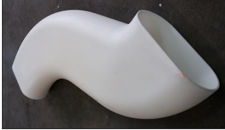
Şekil 4. 53 SLS prototip parça örneği
