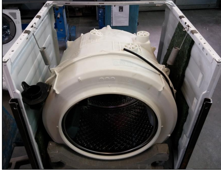
Şekil 4. 61 Tahrik grubunun gövde içerisine yerleştirilmesi (ön)
