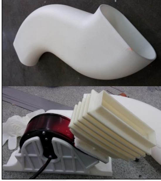
Şekil 4. 65 Kondanser soğutma grubu
