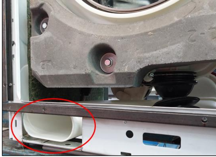
Şekil 4. 69 Kondanser soğutma grubu soğuk hava girişi
