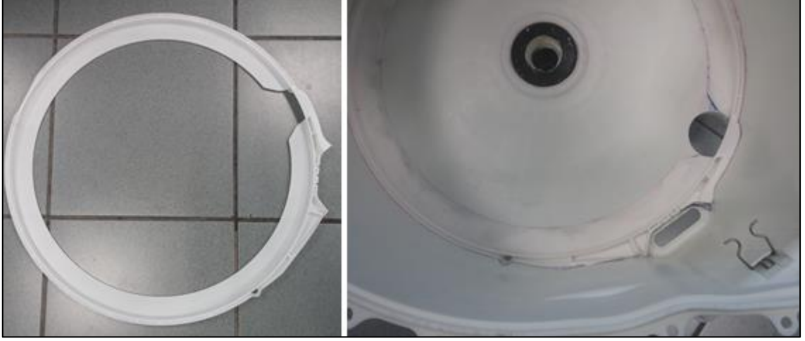
Şekil 4. 90 Kazan arka feder prototipi ve montajı
