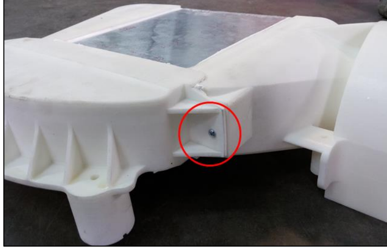
Şekil 4. 63 Kondanser grubu vida bağlantısı
