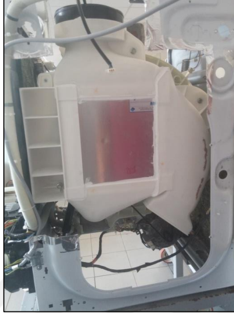
Şekil 4. 99 Final prototip kondanser grubu montaj hali
