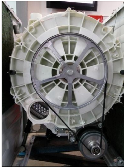
Şekil 4. 60 Tahrik grubunun gövde içerisine yerleştirilmesi (arka)
