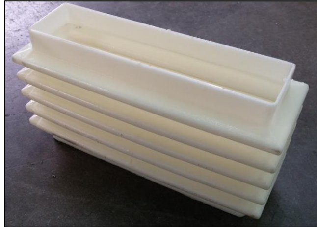
Şekil 4. 55 Silikon kalıptan alınmış prototip parça örneği
