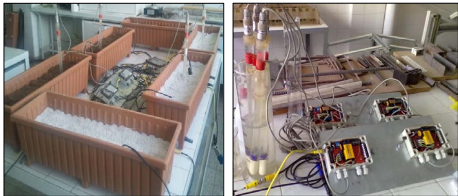
Şekil 3.16. Theta-Probe ML2'nin ortamlara özel kalibrasyonu için yapılan çalışma
