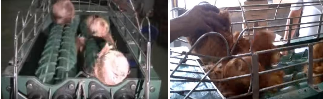
Şekil 2.7: Farklı tipte sıyrıcı meyve dış kabuğu uzaklaştırma makinaları (Youtube 2017, Youtube 2012).
