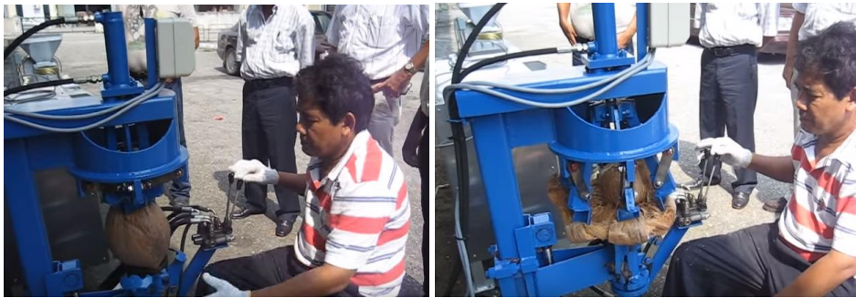
Şekil 2.5: Motorlu meyve dış kabuğu uzaklaştırma makinası (Youtube 2008).
