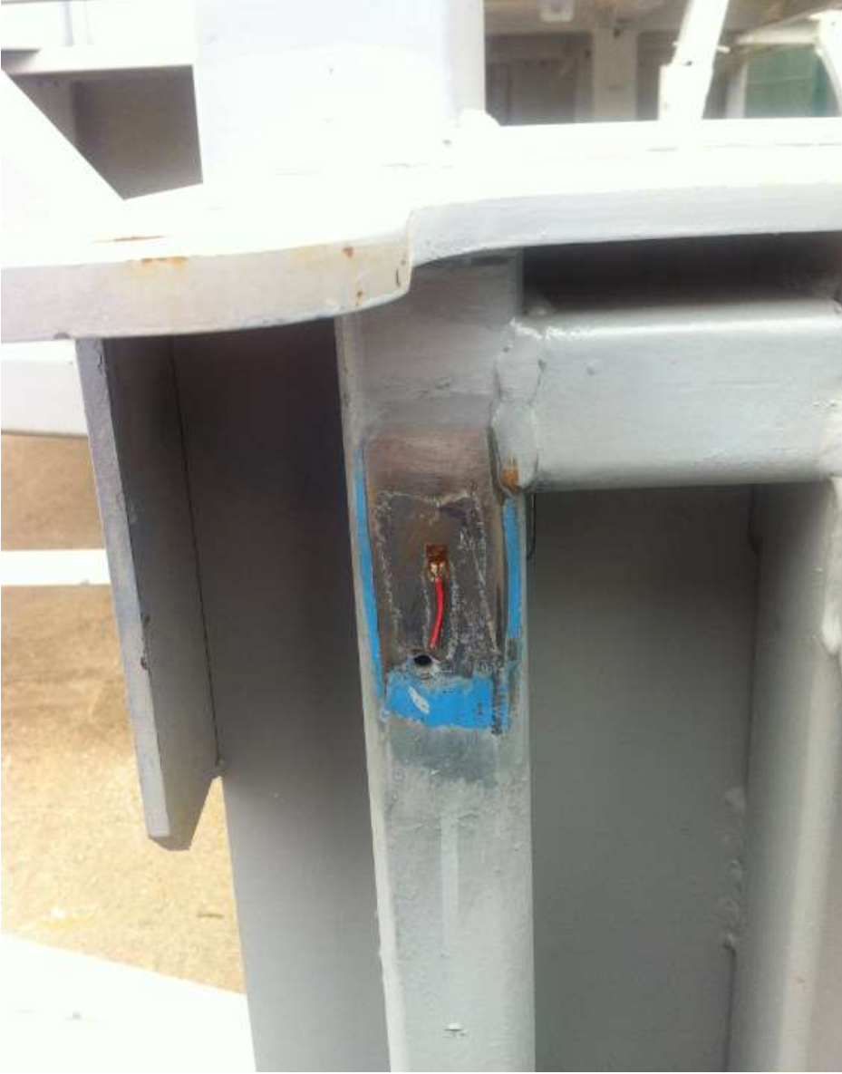
Şekil 7. Omega Sta 135°'lik Rozet Tipi Strain Gage
