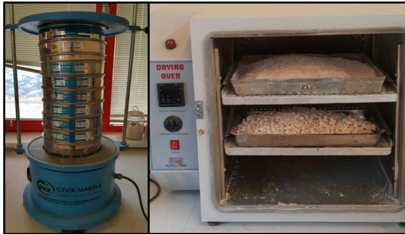
Şekil 3. 2. Granülometri için kullanılan elek takımları ve etüv.
