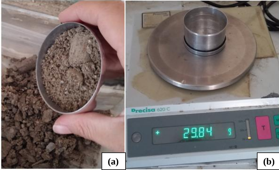
Şekil 3.13. Gravimetrik yöntemle alınan toprak örneklerinin: (a): Kuru ağırlığı tartılan örneklerin toprağının boşaltılması, (b): Boşaltılan örnek kabının darasının tartılması
