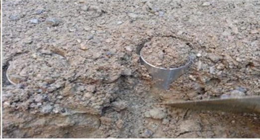
Şekil 3.6. Bozulmamış toprak örneği alım aşamasında silindirlerin toprak katmanına çakılmasından sonra çıkarılması
