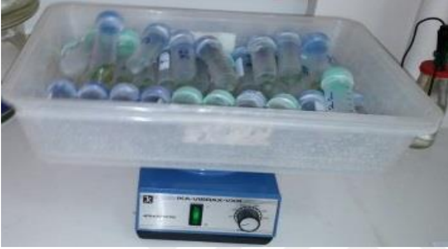
Şekil.3.24. Elektrolit sızıntısı ölçüm aşamalarında falkon tüpüne konulan kestane yaprak örneklerinin çalkalayıcıda inkübe edilmesi
