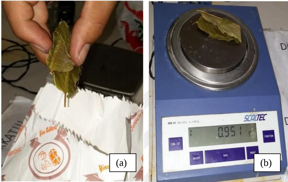
Şekil 3.21. Yaprak oransal su içeriğinin analiz aşamalarındaki: (a): Etüvden çıkarılan kestane yaprak örnekleri; (b): Etüvden çıkan kestane yaprak örneklerinin kuru ağırlığının tartılması
