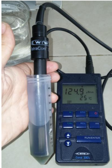
Şekil 3.25. Elektrolit sızıntısı ölçüm aşamalarında, çalkalayıcıda inkübe edildikten sonra çıkarılan kestane yaprak örneğinin EC1 okumasının yapılması
