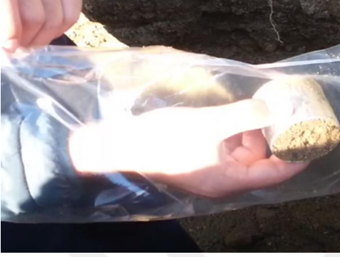
Şekil 3.7. Bozulmamış toprak örneğinin poşetlere konulması
