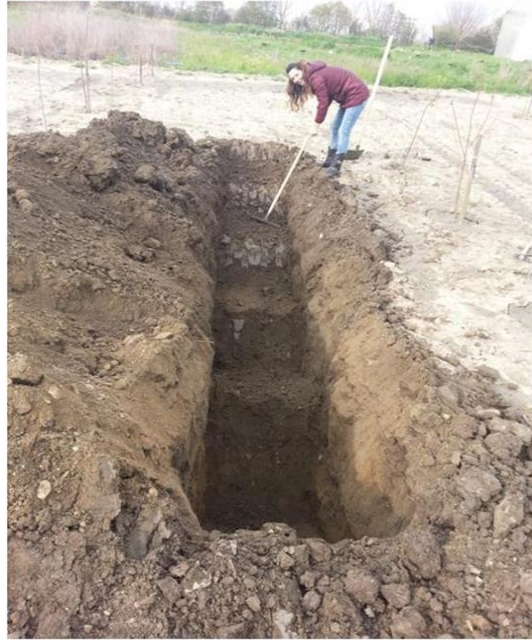
Şekil 3.4. Fiziksel ve kimyasal toprak örnekleri için profil açma işlemi
