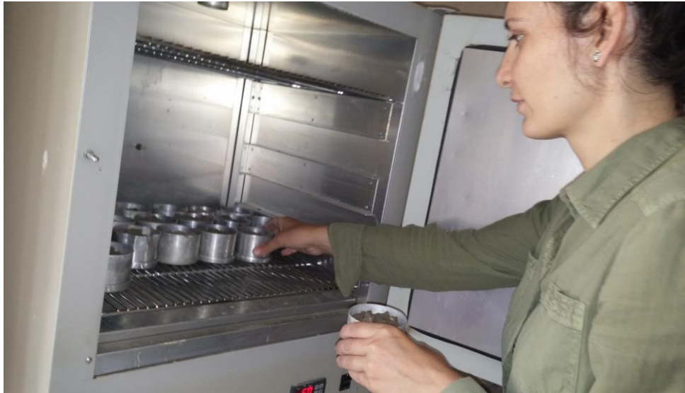
Şekil 3.12. Gravimetrik yöntemle alınıp etüve konulan toprak örneklerinin etüvden çıkarılması
