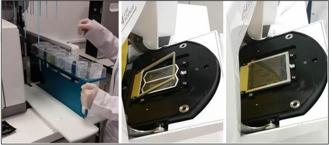
Şekil 3.9 Dizileme reaktiflerinin ve PicoTiterPlate'in cihaza yerleştirilmesi
