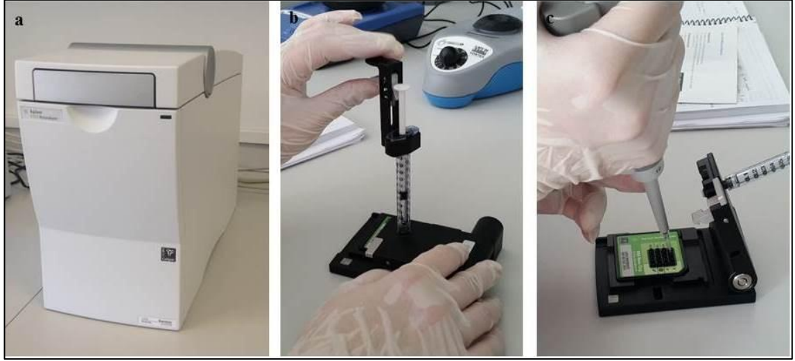
Şekil 3.4 Parçalanma işleminin biyoanalizör cihazı ile kontrol edilmesi
