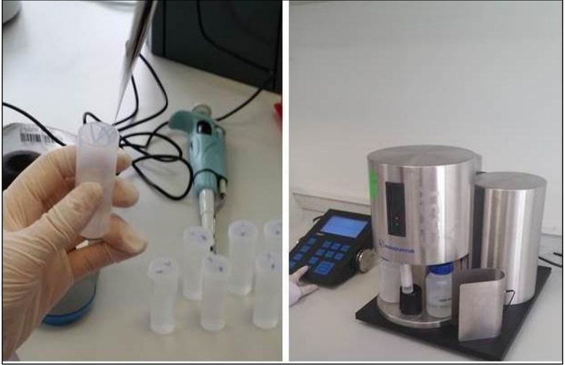
Şekil 3.7 Örneklerin boncuk miktarının hesaplanması için hazırlanması ve Casy cihazı
