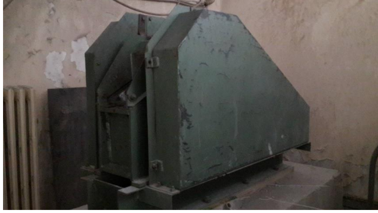
Şekil 4.2. Laboratuvar tipi çeneli kırıcı
