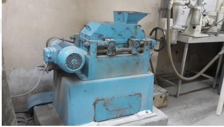
Şekil 4.3. Laboratuvar tipi merdaneli kırıcı
