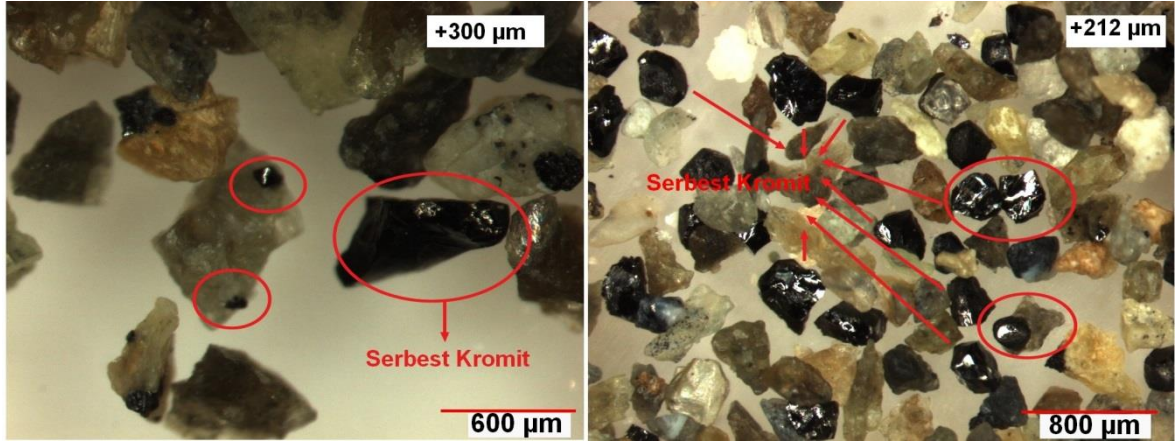
Şekil 4.18. +300, +212 µm boyunda tüvenan cevherin stereomikroskop görüntüsü
