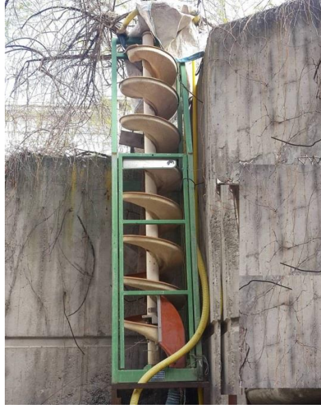
Şekil 4.8. Mineral Deposit A87D türünde spiral zenginleştirici
