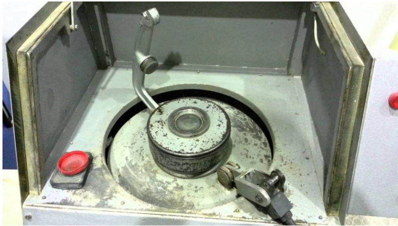
Şekil 4.4. Laboratuvar tipi halkalı değirmen
