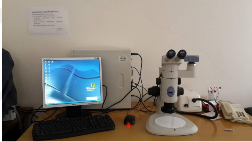
Şekil 4.5. Clemex Vision P.E 5.0 donanımlı stereomikroskop
