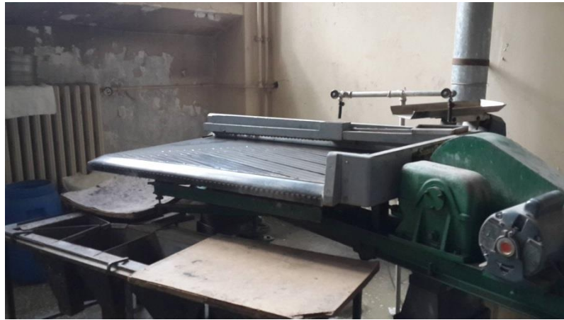
Şekil 4.7. Laboratuvar ölçekli sallantılı masa
