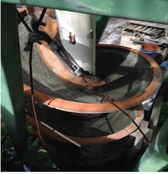
Şekil 4.25. Spiral zenginleştirme testi
