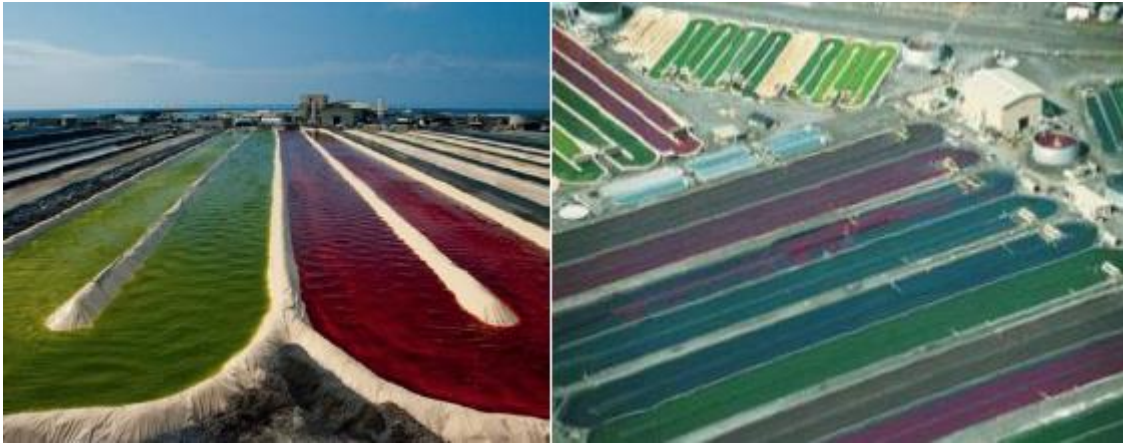
Şekil 1. 1 Açık havuz tipi alg üretim sistemleri [16]
