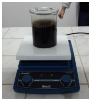
Şekil 3.3. Portakal küspesinin \text{ZnCl}_2 ile aktivasyon işlemi
