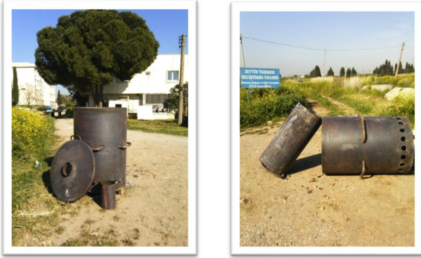
Şekil 3.3 ve 3.4. Çift varil metoduyla biyokömür üretiminde kullanılan düzenek.
