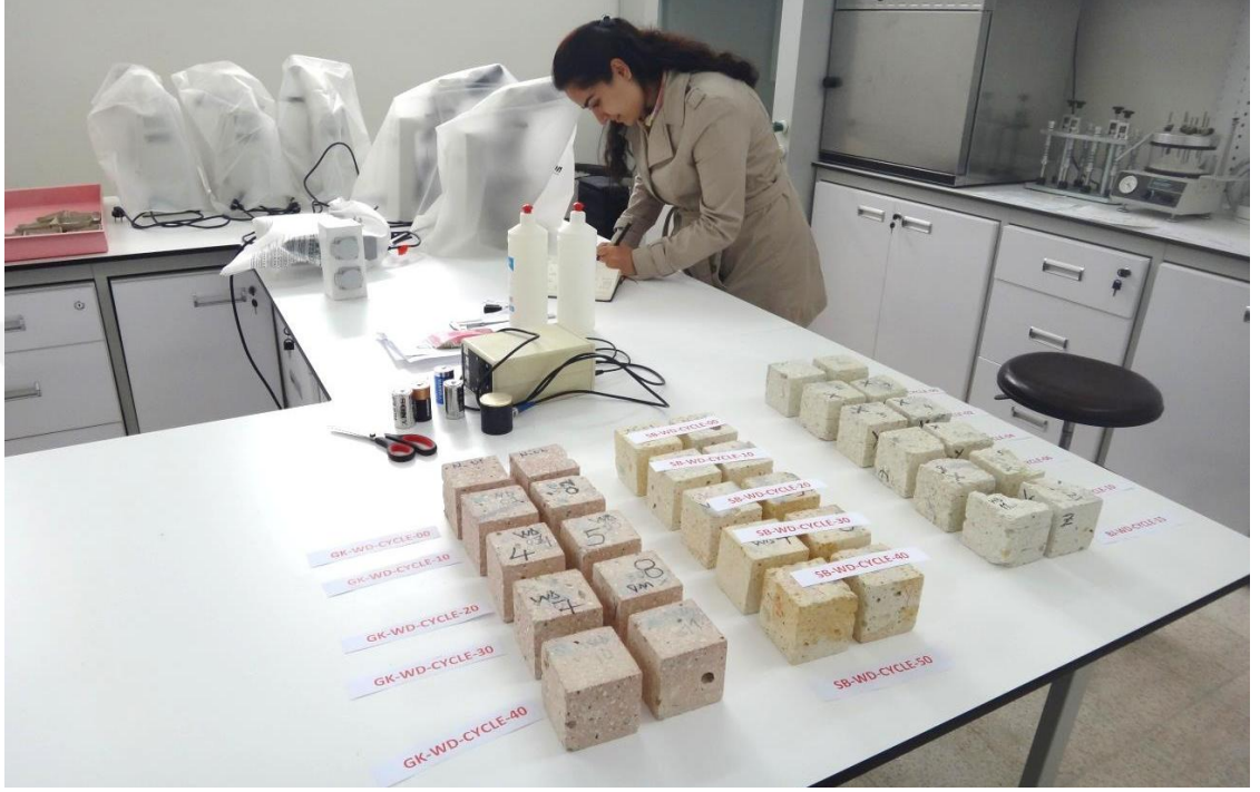
Resim 3.2. P-dalga hızının ölçümünden genel görünüm
