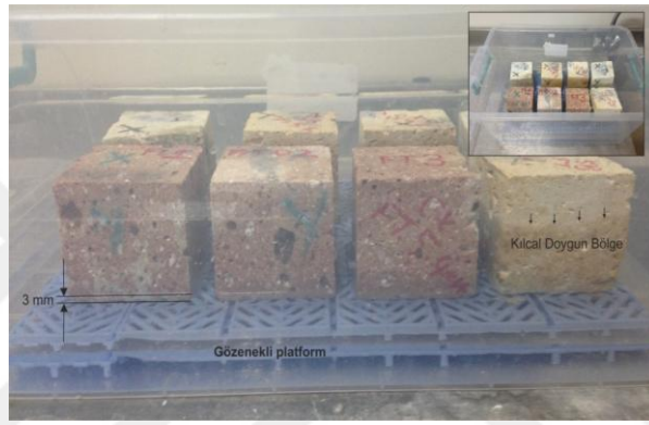
Resim 3.6. Kılcal etkiye bağlı su emme deneyinden bir görünüm
