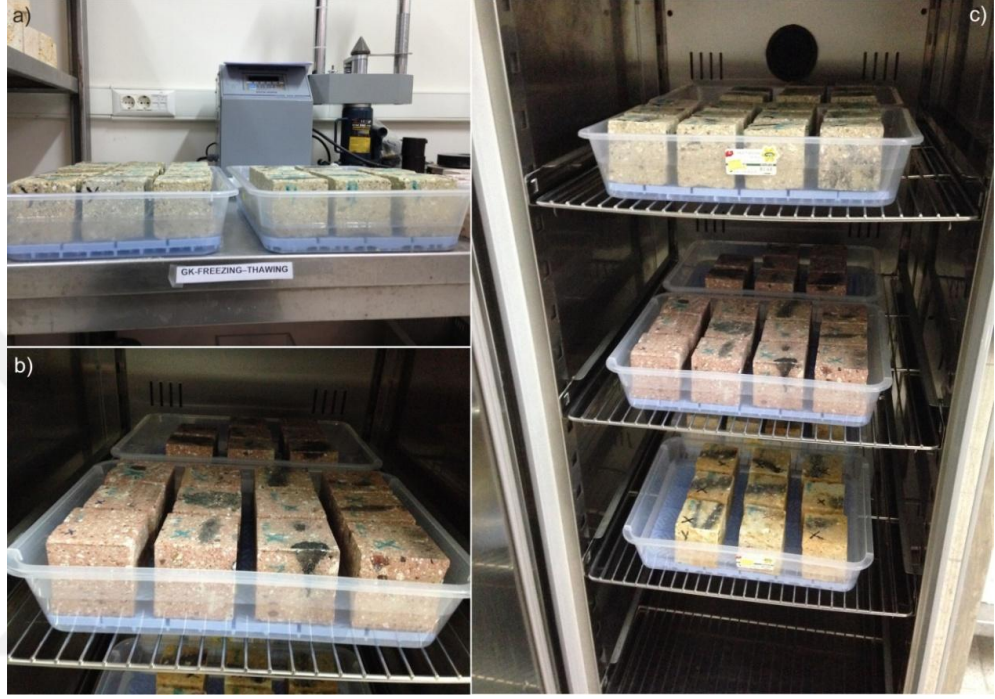
Resim 3.4. Donma-çözülme deneyin yapımından genel görünüm
