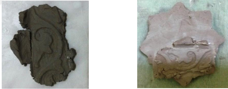
Fotoğraf 120: Alçı Kalıplardan Çıkmış Motiflerin Görüntüsü
