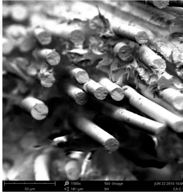
Şekil 7. 33 Vinilester matrisli E-camı fiber takviyeli %10 alüminyum hidroksit dolgulu numuneden elde edilen sem görüntüsü
