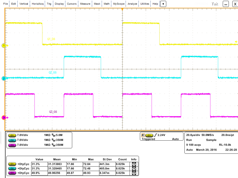
Şekil 4.18 iDSBB düşürücü çalışma için “gate – source” işaretleri
