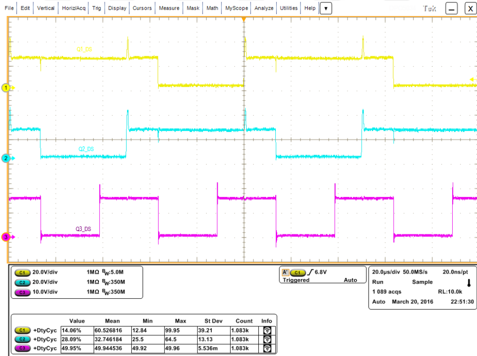
Şekil 4.19 iDSBB düşürücü çalışma için “drain-source” işaretleri
