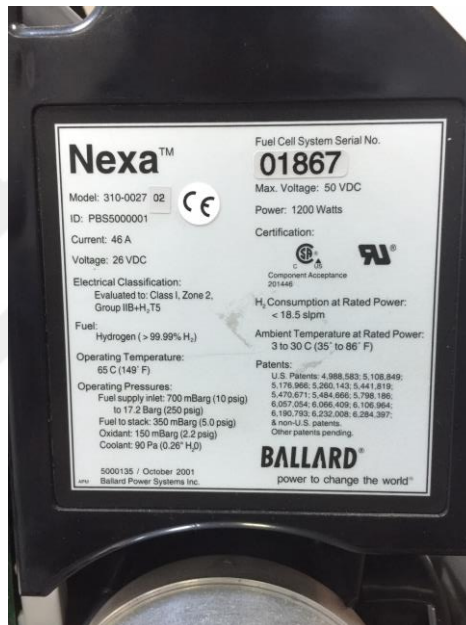
Şekil 4.10 Nexa™ PEM Tipi yakıt pili etiket değerleri
