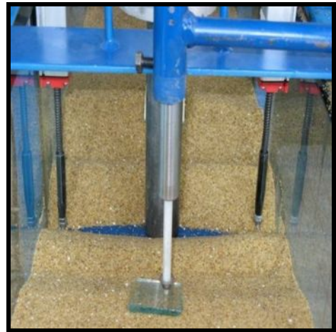
Şekil 5-39 Donatılı zemin deneylerine ilişkin görüntüler ( B=4 cm, N=1 , u=1 cm, L_g=16 cm, D_f=0 cm).
