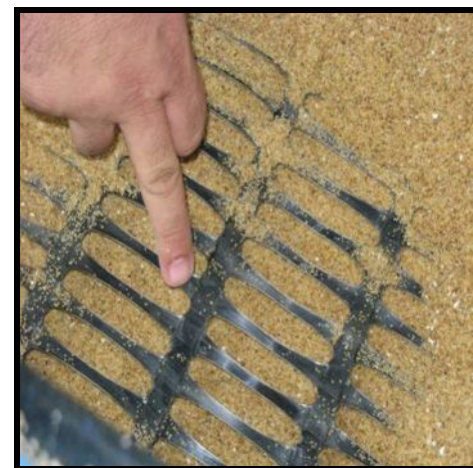
Şekil 5-41 Donatılı zemin deneylerine ilişkin görüntüler ( B=6 cm, N=4 , u=4.5 cm, L_g=36 cm, D_f=0 cm).
