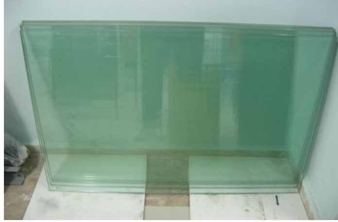
Şekil 5-11 Deneylerde kullanılan temperli (zırhlı) camlar
