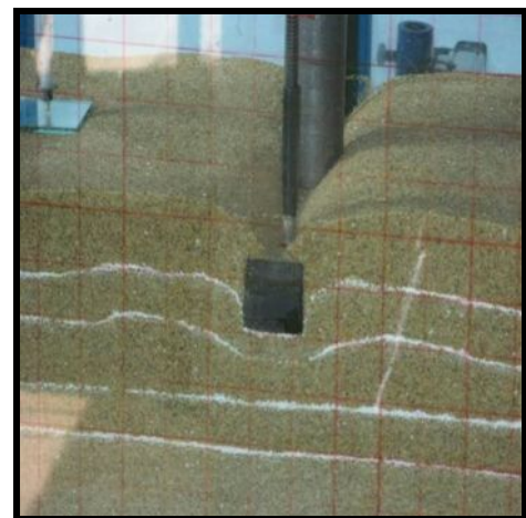
Şekil 5-40 Donatılı zemin deneylerine ilişkin görüntüler (B=4 cm, N=2, u=3 cm, L_g=32 cm, D_f=4 cm).
