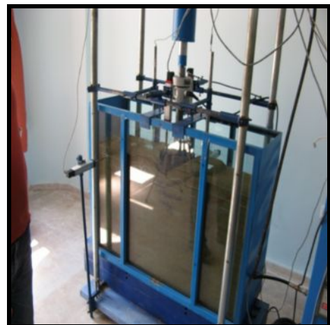
Şekil 5-42 Donatılı zemin deneylerine ilişkin görüntüler ( B=8 cm, N=2 , u=6 cm, L_g=64 cm, D_f=0 cm).
