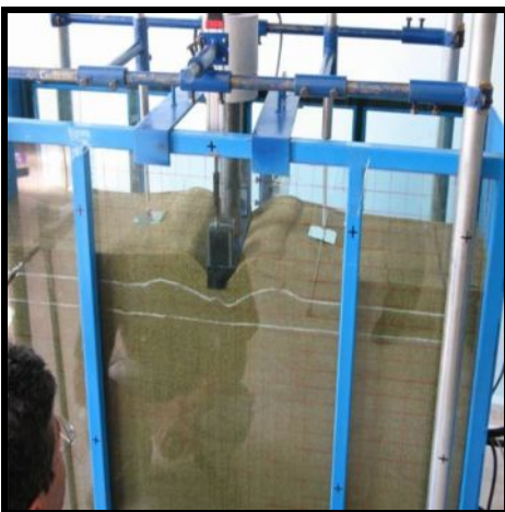
Şekil 5-41 Donatılı zemin deneylerine ilişkin görüntüler ( B=6 cm, N=4 , u=4.5 cm, L_g=36 cm, D_f=0 cm).
