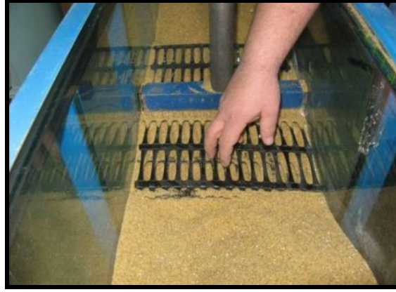
Şekil 5-26 Donatı ve donatının kum zemin içerisine yerleştirilmesi
