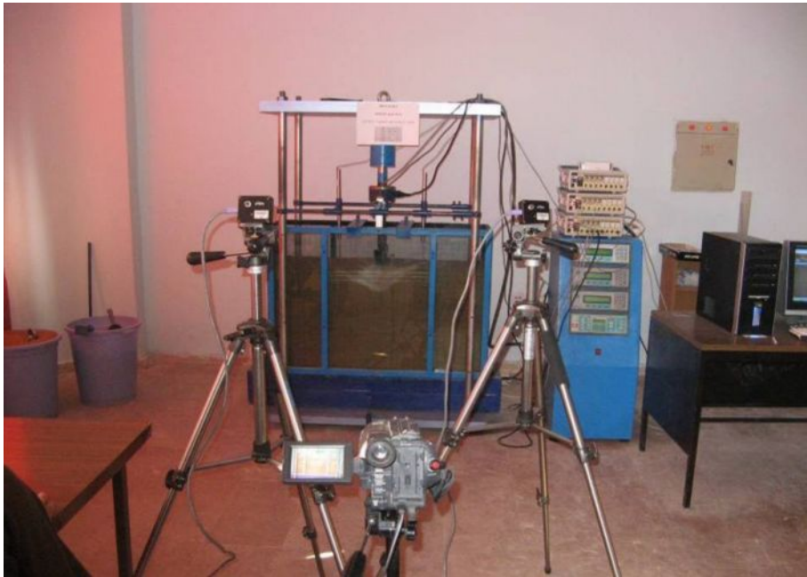
Şekil 5-18 Deneylerde kullanılan düşey yük ölçüm düzeneği
