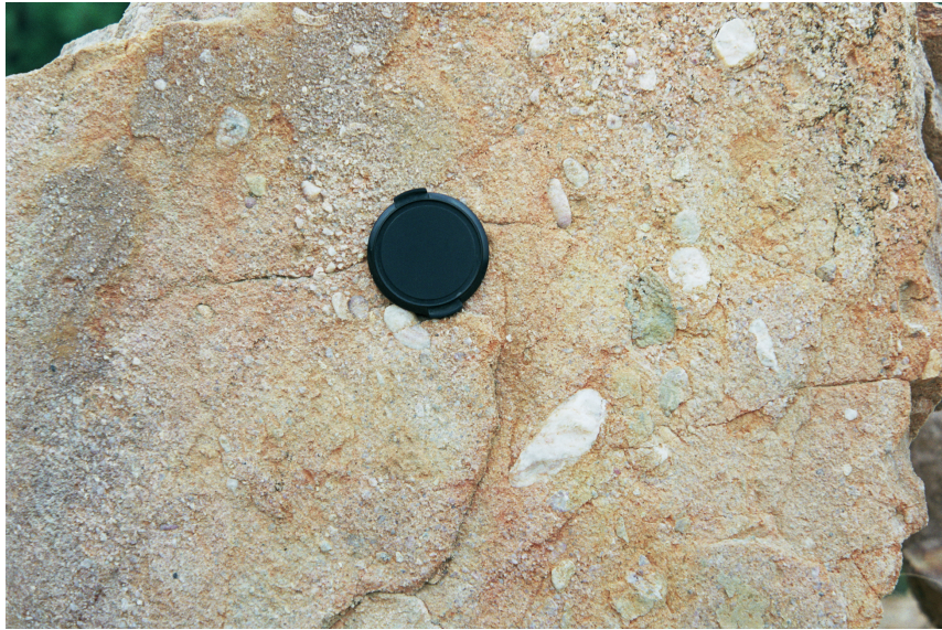
Şekil 2.9. Zabuk Formasyonu'nun çakıllı metakumtaşlarında yarı yuvarlak-yarı köşeli kuvarsa zengin çakıllar.
