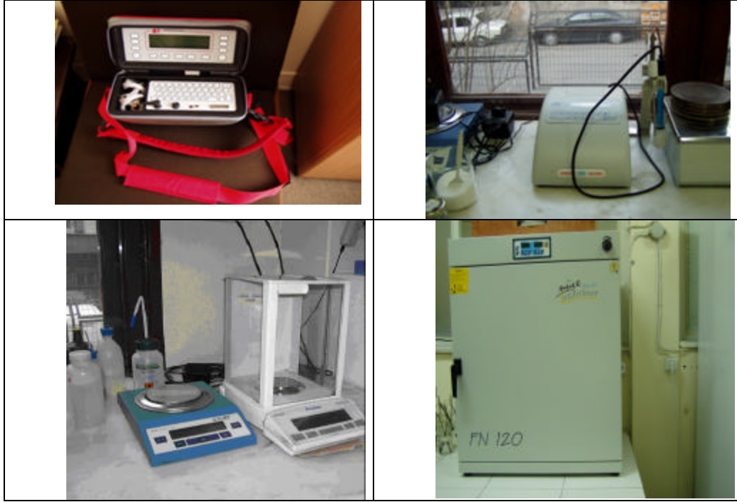
Sekil 3.6. Denemede kullanılan ekipmanlar. Sol üstte stoma iletkenligi ölçer, sag üstte pH metre, alt sagda hassas terazi, alt solda etüv.
