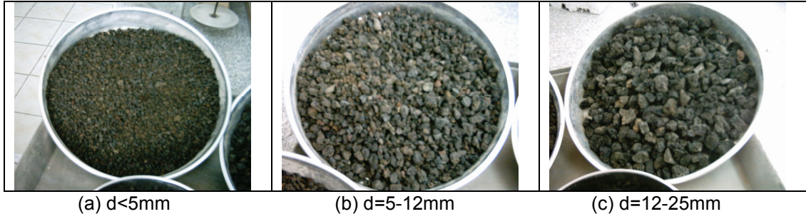
Şekil 4.2. Karışımda kullanılan ince (a), orta (b) ve iri (c) bazik pomza agregaları.
