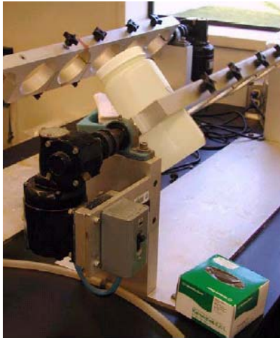
Şekil 2.12. TCLP ve SPLP proseslerinde numune ekstraksiyonunda kullanılan döner çalkalama aygıtı (Pendowski vd.’nden, 2003).
