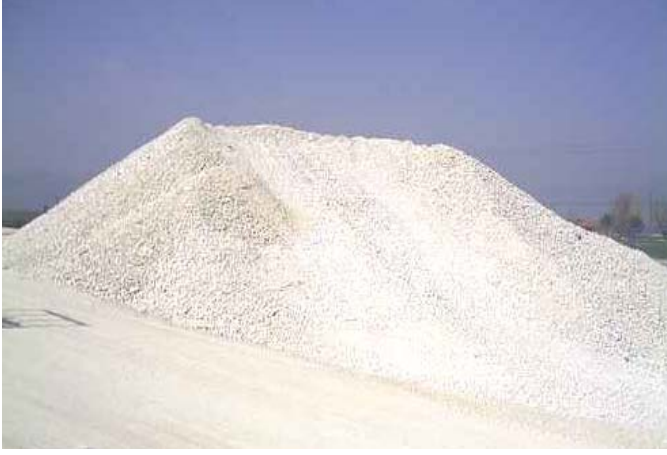
Şekil 2.5. Kırıcıdan geçmiş atık mermer malzemeleri
