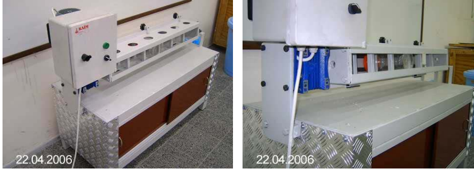
Şekil 3.7. Liç deney aletinin farklı görünüşleri
