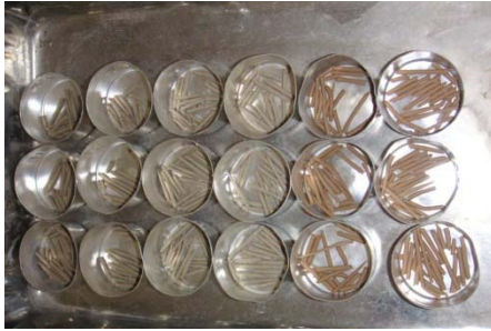
Şekil 3.6. Plastik limit örneklerinin su muhtevalarının saptanması
