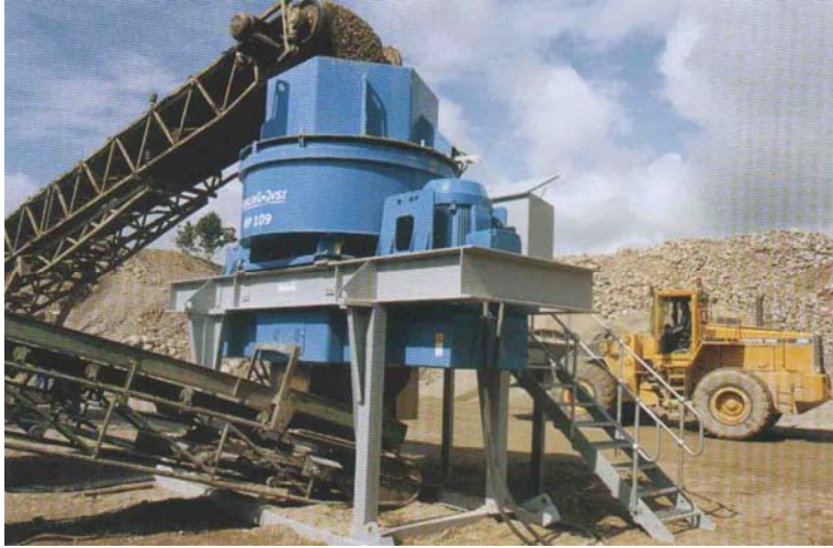
Şekil 2.10. Düşey milli kırıcı (Yıldız, 2007)
