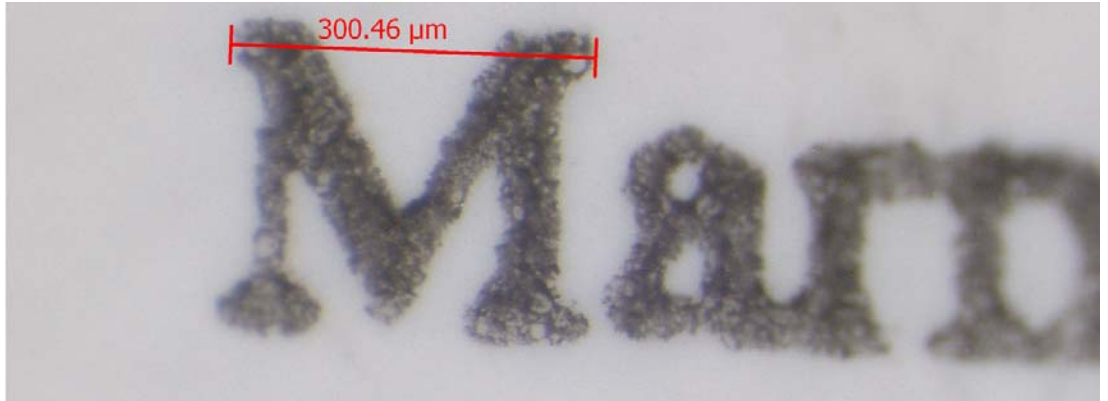
Şekil III-20 5 Nolu Baskıdaki 1 pt Yazının 160 Defa Büyütülmüş Görüntüsü
