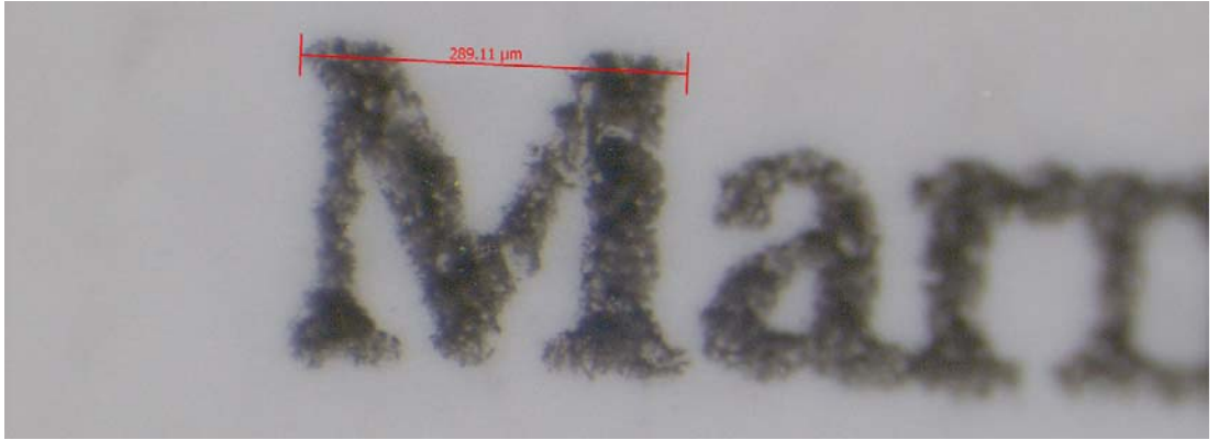
Şekil III-36 9 Nolu Baskıdaki 1 pt Yazının 160 Defa Büyütülmüş Görüntüsü
