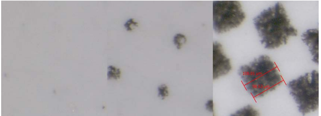
Şekil III-37 9 Nolu Baskıdaki %1, %5 ve %50 Tramton Değerindeki Noktaların 160 Defa Büyütülmüş Görüntüsü
