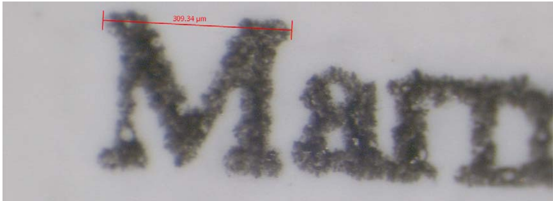
Şekil III-52 13 Nolu Baskıdaki 1 Pt Yazının 160 Defa Büyütülmüş Görüntüsü
