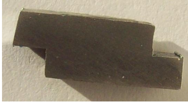
Şekil 6-4.P=2.5 MPa, t=180 dak şartlarında birleştirilmiş %20 SiCp/AlMg3 - %20 SiCp/AlMg3 numune çifti
