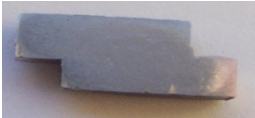
Şekil 6-2. P=2.5 MPa, t=180 dak şartlarında birleştirilmiş %0 SiCp/AlMg3 - %0 SiCp/AlMg3 numune çifti
