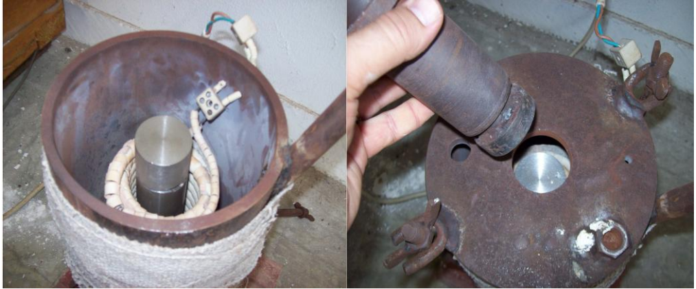
Şekil 5-4. Numune Aparatının Difüzyon Fırınına Yerleştirilmesi ve Ağırlık Platformunun Montajı
