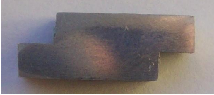
Şekil 6-3.P=1.5 MPa, t=180 dak şartlarında birleştirilmiş %0 SiCp/AlMg3 - %0 SiCp/AlMg3 numune çifti
