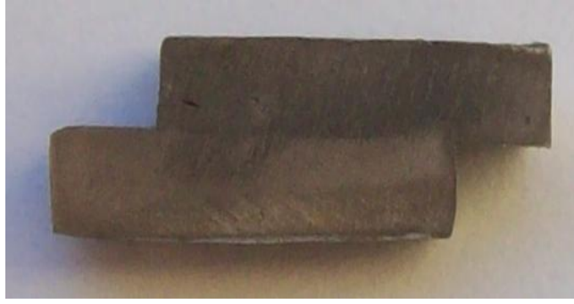
Şekil 6-1 P=3.5 MPa, t=180 dak şartlarında birleştirilmiş %0 SiCp/AlMg3 - %10 SiCp/AlMg3 numune çifti
