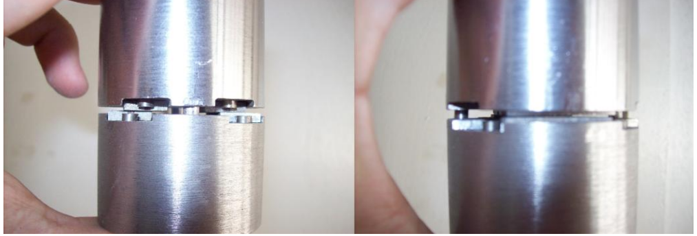
Şekil 5-3. Numunelerin Aparata Yerleştirilmesi
