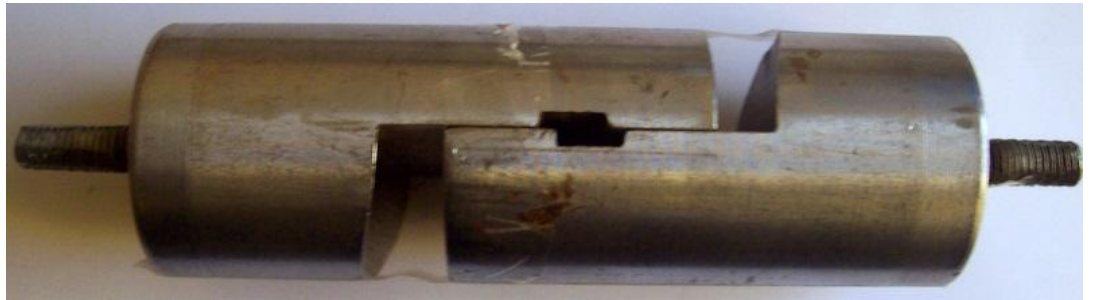
Şekil 5-7. INSTRON Çekme Cihazı İçin Hazırlanmış Kesme Testi Aparatı
