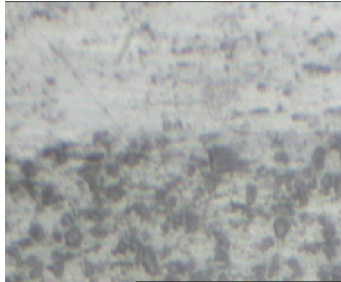
Şekil 6-6.% 0 SiCp/AlMg3 - % 20 SiCp/AlMg3 numune çifti
