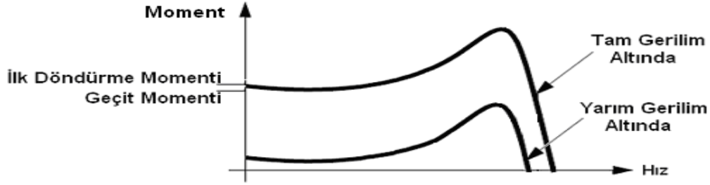
Şekil 4.29. Bilezikli bir motorun döndürme hız-moment karakteristiği
