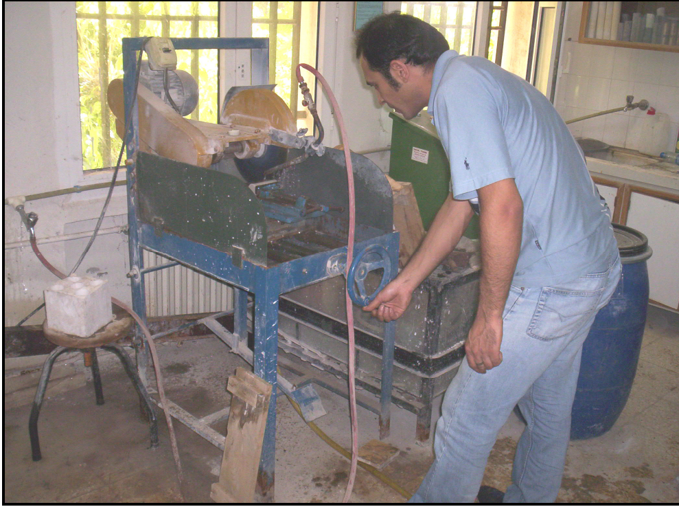
Şekil 5.8. Taş kesme testeresi ile numune boyutlandırma.
