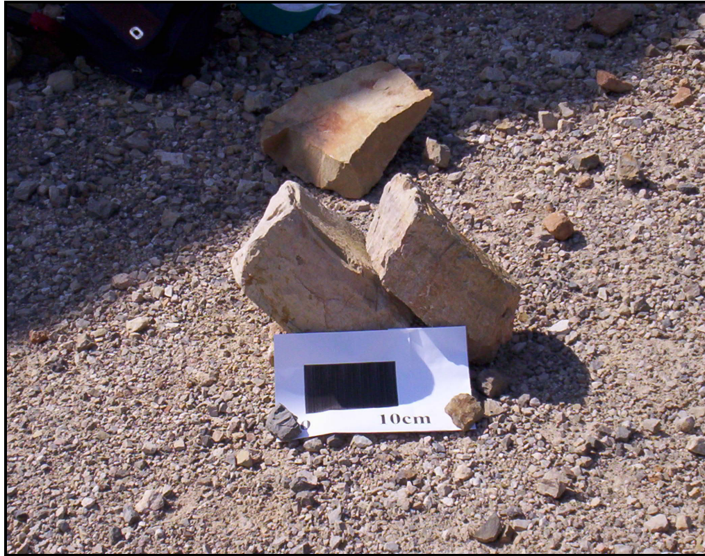
Şekil 5.6. Arazide tilt test ile şev sınır eğimi tahmini.
