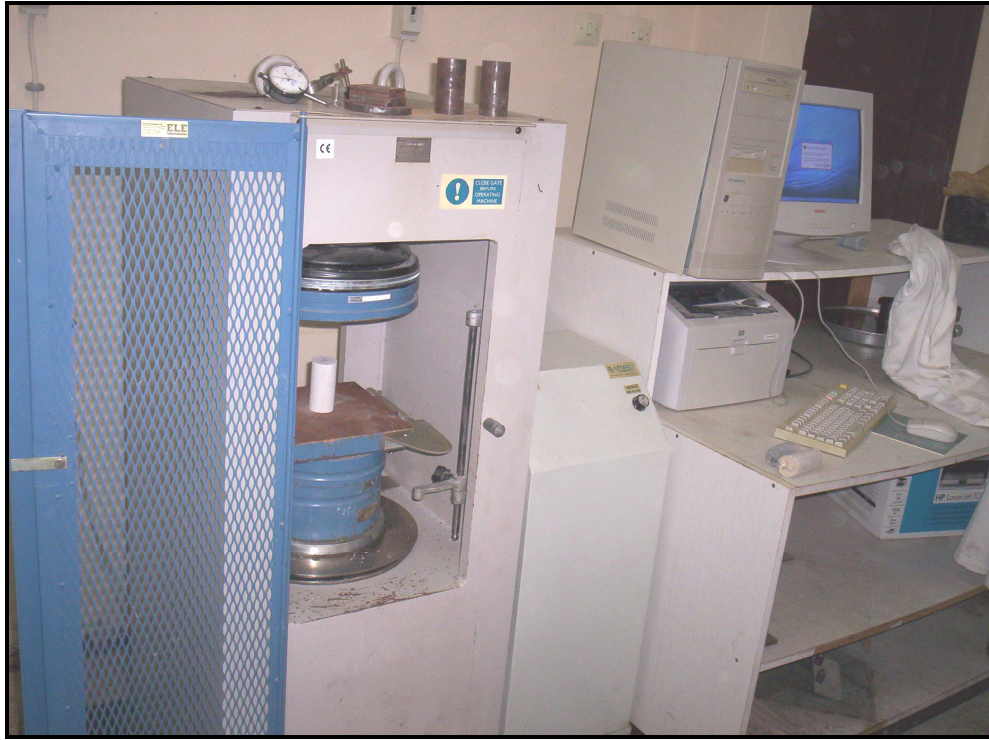
Şekil 5.11. Tek eksenli basma dayanımı deney aleti (deney presi).
