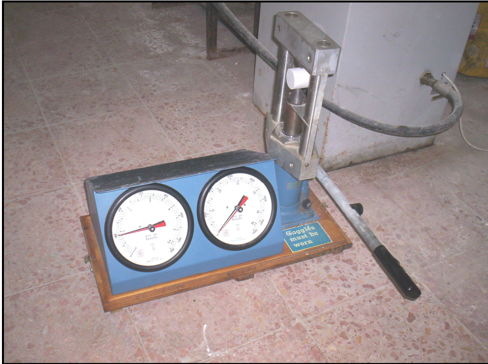
Şekil 5.9. Nokta yükü dayanım indeksi deney aleti.
