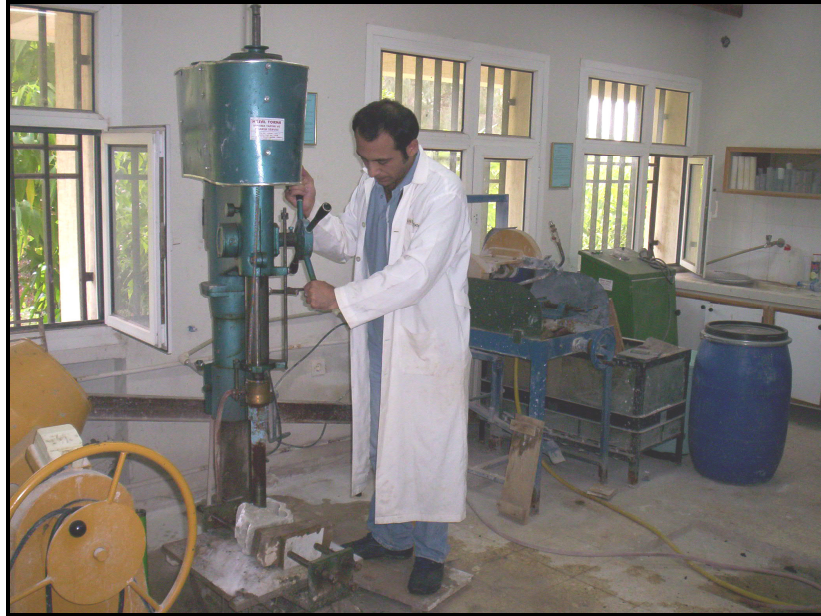
Şekil 5.7. Karotiyer yardımıyla blok numuneden karot numune eldesi.
