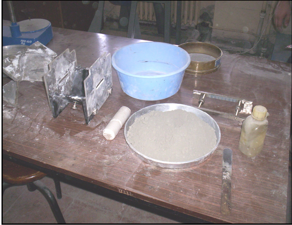
Şekil 5.12. Makaslama dayanımı deneyi için numune hazırlama.
