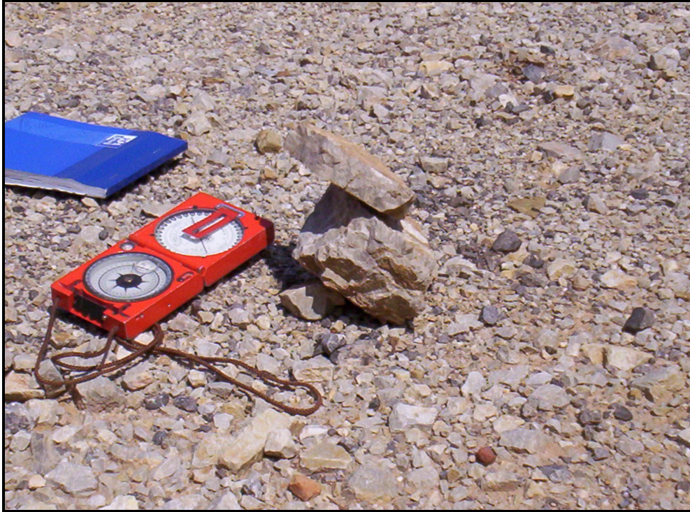
Şekil 5.2. Ekleme doğrultu ve eğimlerini ölçmede kullanılan inklinometreli pusula.
