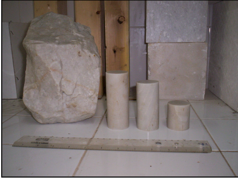
Şekil 5.10. Deney için kesilip-boyutlandırılmış karot numuneler.
