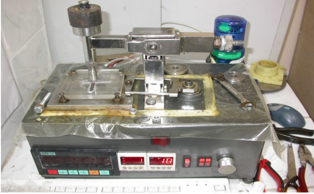
Şekil 4.8. Aşınma deney düzeneği resmi
