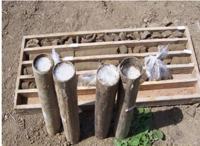
Şekil 3.5. Araziden Alınan Örselenmiş ve Örselenmemiş Zemin Numuneleri
