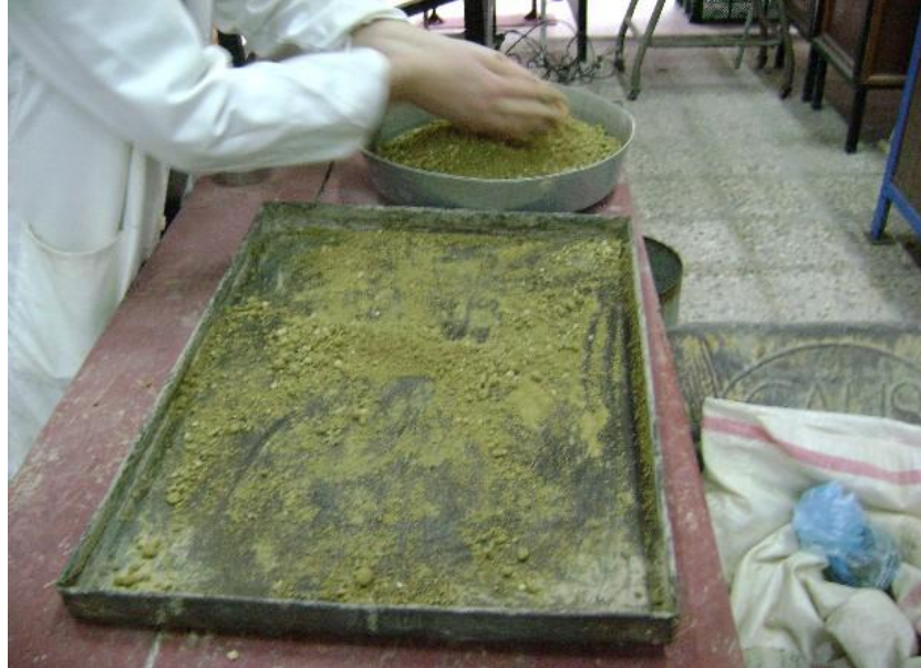
Şekil 3.14. Granüler Dolgu Malzemesinin Hazırlanması
