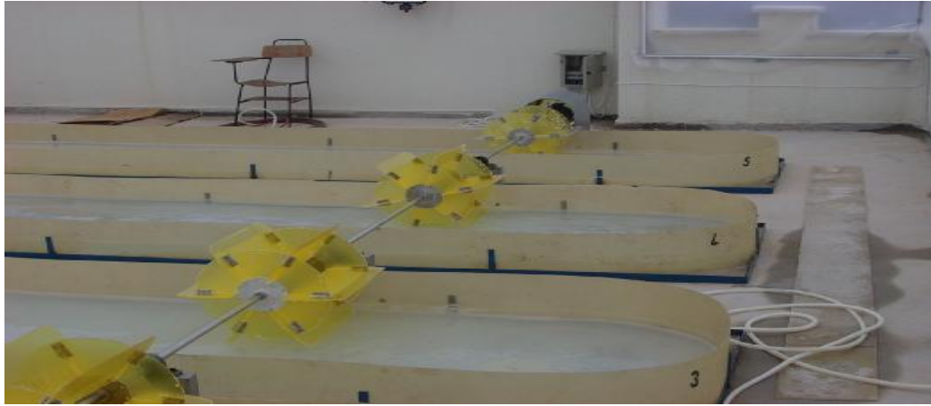
Şekil 3.3. Karışımı Sağlayan Pedal Sistemi
