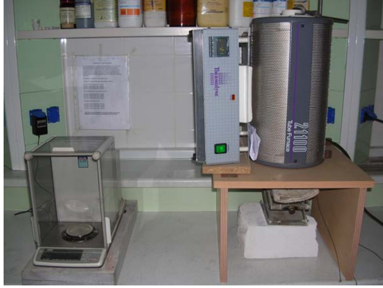
Şekil 3.7 Ani Soğutmalar İçin Kullanılan Dikey Tüp Fırını.
