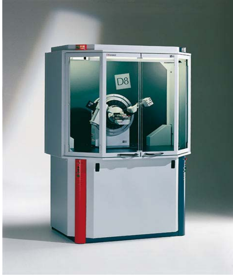
Şekil 2.3 X-ışınları Toz Difraksiyon Ölçümleri (XRD) İçin Kullanılan Bruker AXS D8 Advanced Tipi Difraktometre.
