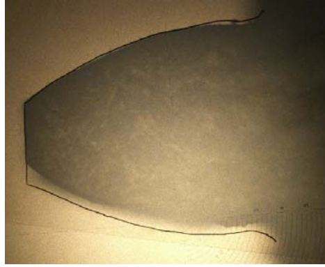
Şekil 7.13. PA 66 GFR 30/PA 66 GFR 30 1000 dev/dak modül 4,5, 39,18 N/mm diş yükü deney sonucunda diş profilinde meydana gelen aşınma
