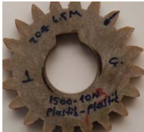
Şekil 7.27. 1500 dev/dak 38,75 N/mm diş yükü , a) Modül 3.5 PA 66 GFR 30 – PA 66 GFR 30 eş dişli, b) Diş hasarı
