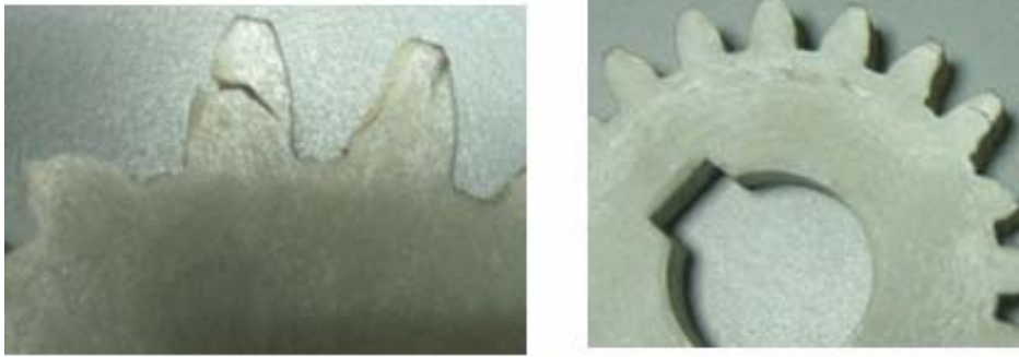
Ek.2.5 PA 66 GFR 30 Dişli çark dişinde meydana gelen diş kırılma hasar örnekleri
