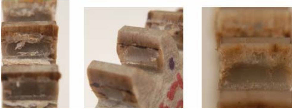
Ek.2.2 PA 66 GFR 30 Dişli çark dişinde meydana gelen termal hasar örnekleri
