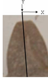
Şekil 7.2. Ölçölen diř görünümü (Yarı diř x: diř profili, y: diř yüksekliđi)
