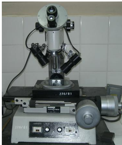
řekil 6.13. Scherr Tumico Profil aşınma  l  me cihazı
