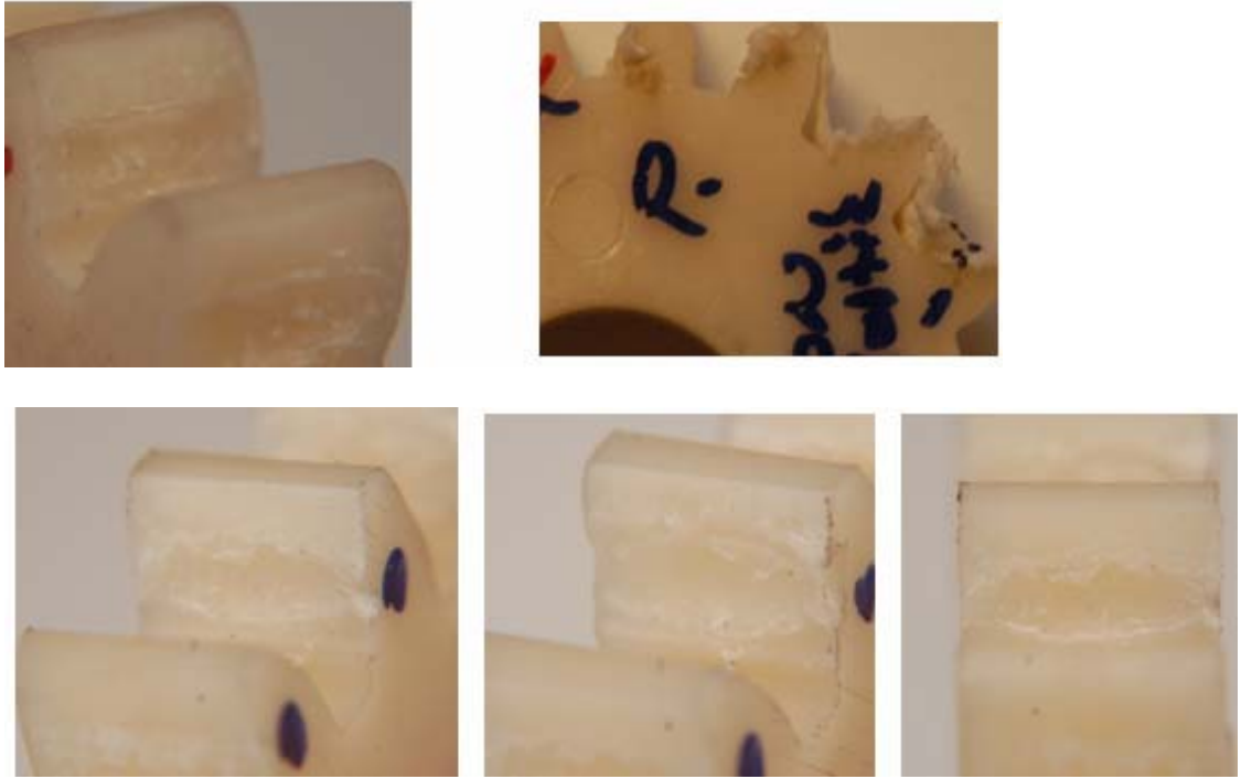
Ek.2.4 ABS/PC Dişli çark dişinde meydana gelen termal hasar örnekleri
