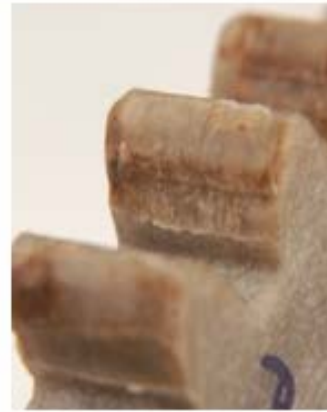
Şekil 7.27. 1500 dev/dak 38,75 N/mm diş yükü , a) Modül 3.5 PA 66 GFR 30 – PA 66 GFR 30 eş dişli, b) Diş hasarı
