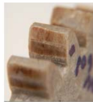
Şekil 7.12. 1000 dev/dak 39.18 N/mm diş yükü, a) Modül 4.5 PA 66 GFR 30-PA 66 GFR 30 eş dişli, b) Diş hasarı
