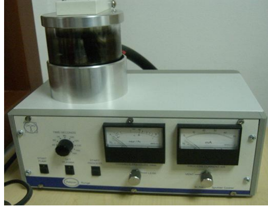
Şekil 6.15. Polaron Range SC7620 Sputter Coater marka atın platinyum kaplama cihazı
