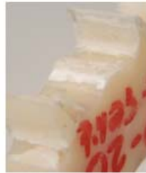
Şekil 7.35. 1500 dev/dak 29.7 N/mm diş yükü , a) Modül 4.5 ABS/PC-AISI 8620 eş dişli, b) Diş hasarı
