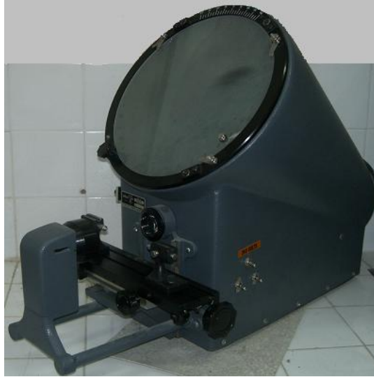
Şekil 6.14. Profil ölçme cihazı
