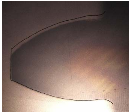
Şekil 7.45. ABS/PC-ABS/PC 1500 dev/dak modül 4.5, 16.07 N/mm diş yükü deney sonucunda diş profilinde meydana gelen aşınma
