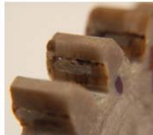
Şekil 7.4. 1000 dev/dak 65.53 N/mm diř yükü, a) Modöl 4.5 PA 66 GFR 30-AISI 8620 eş diřli, b) Diř hasarı
