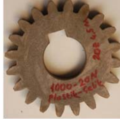
Şekil 7.3. PA 66 GFR 30-AISI 8620 1000 dev/dak modöl 4.5 deđiřik yüklemde oluřan diř profilinde oluřan ařınma derinliđi
