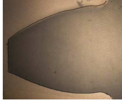
Şekil 7.19. PA 66 GFR 30-AISI 8620 1000 dev/dak modül 3.5, 56,13 N/mm diş yükü deney sonucunda diş profilinde meydana gelen aşınma
