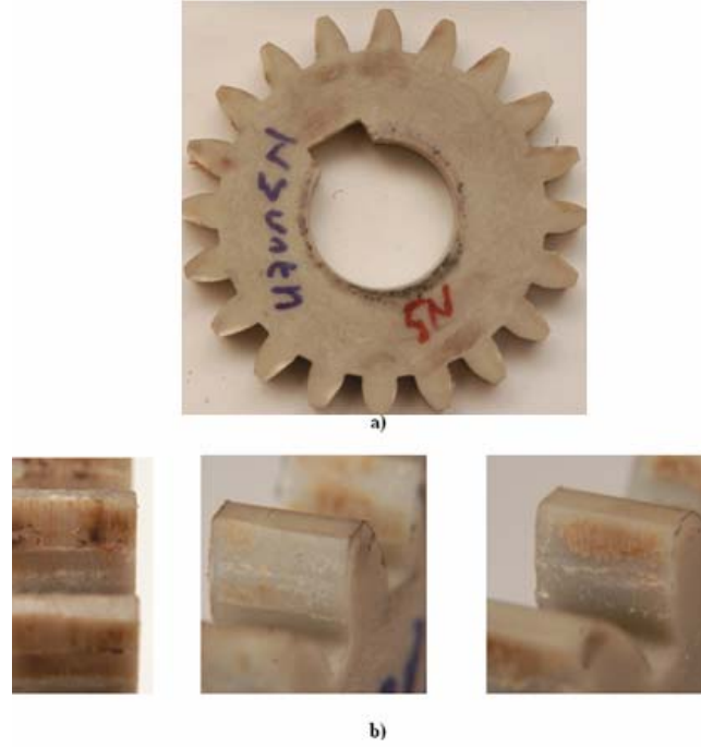
Şekil 7.59. 1000 dev/dak Modül 4.5 74,32 N/mm diş yükü , a) Modül 4.5 PA 66 GFR 30 +%2 borik asit – AISI 8620 eş dişli, b) Diş hasarı
