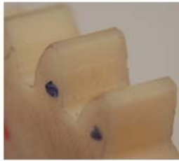
Şekil 7.30. 1000 dev/dak 29.7 N/mm diş yükü , a) Modül 4.5 ABS/PC-AISI 8620 eş dişli, b)Diş hasarı
