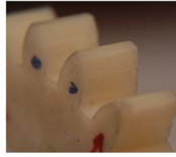
Şekil 7.30. 1000 dev/dak 29.7 N/mm diş yükü , a) Modül 4.5 ABS/PC-AISI 8620 eş dişli, b)Diş hasarı
