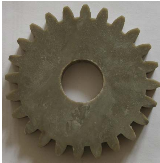
Şekil 6.4. Enjeksiyon sonrası dişli çark görünümü
