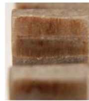
Şekil 7.12. 1000 dev/dak 39.18 N/mm diş yükü, a) Modül 4.5 PA 66 GFR 30-PA 66 GFR 30 eş dişli, b) Diş hasarı
