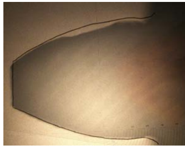
Şekil 7.31. ABS/PC - AISI 8620 1000 dev/dak modül 4.5, 16.07 N/mm diş yükünde deney sonucunda diş profilinde meydana gelen aşınma
