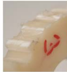
Şekil 7.35. 1500 dev/dak 29.7 N/mm diş yükü , a) Modül 4.5 ABS/PC-AISI 8620 eş dişli, b) Diş hasarı
