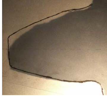
Şekil 7.28. PA 66 GFR 30-PA 66 GFR 30 1500 dev/dak modül 3.5, 38.75 N/mm diş yükü deney sonucunda diş profilinde meydana gelen aşınma
