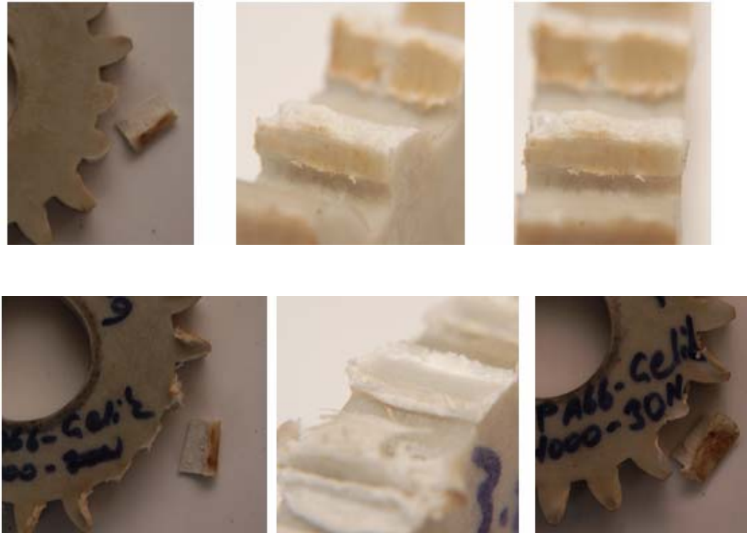
Ek.2.4 ABS/PC Dişli çark dişinde meydana gelen termal hasar örnekleri
