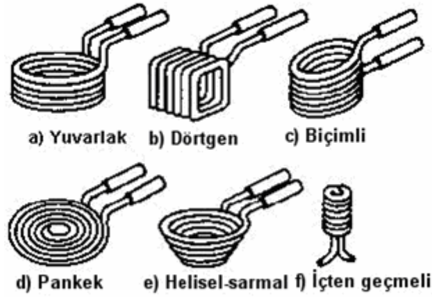
Şekil 3.3 Değişik şekilli, endüksiyonla ısıtma amaçlı çok sarımlı bobinler
