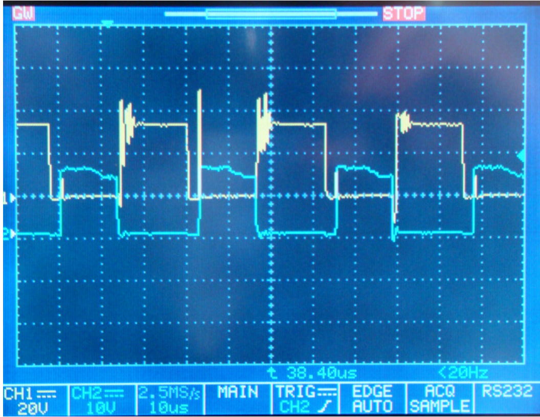
Şekil 7.17 M_2 anahtarına ait V_{DS} ve V_{GS} gerilimleri (CH1 Volt/div=20 V, CH2 Volt/div=10 V, Time/div=10 \mu s)
