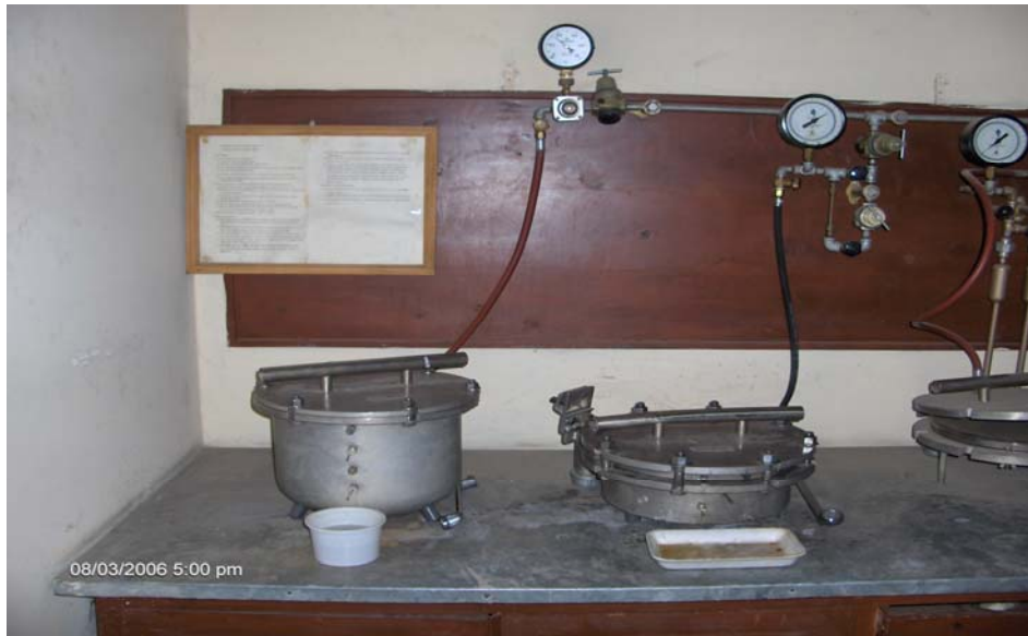
Şekil 3.5. Tarla kapasitesi ve solma noktasının belirlenmesi
