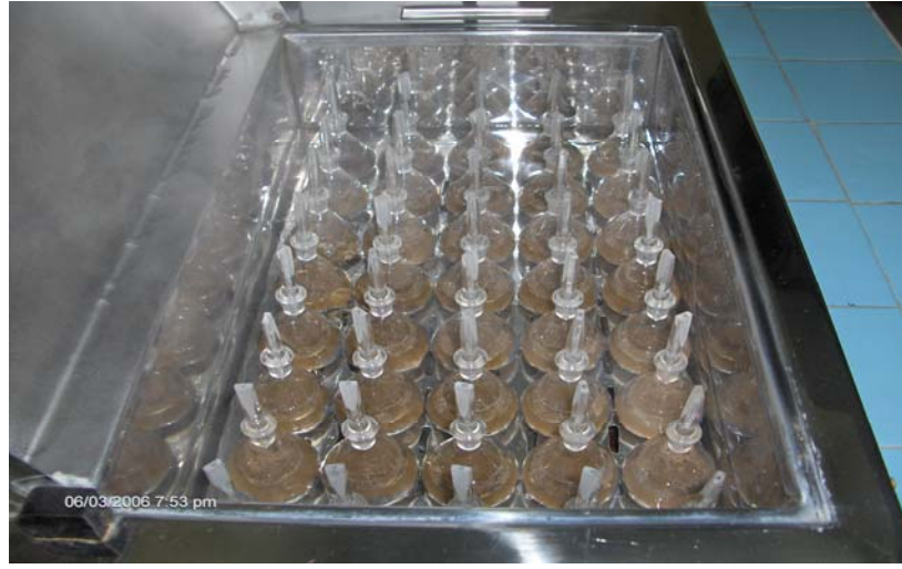
Şekil 3.3. Piknometre yöntemiyle tane yoğunluğu tayini
