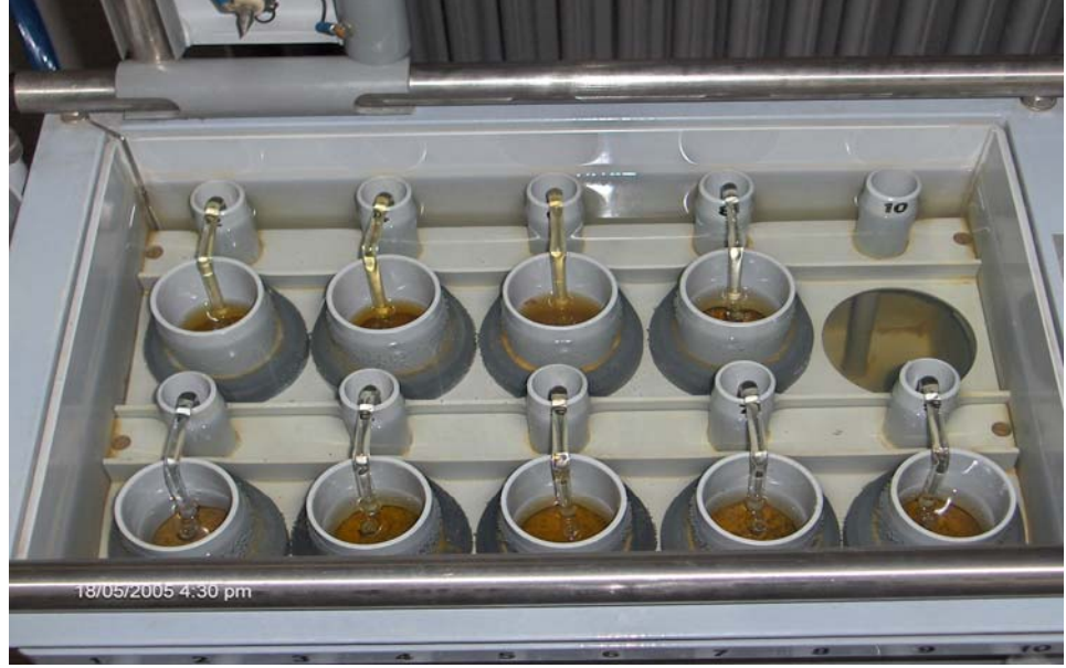
Şekil 3.6. ICW laboratuvar permeametrosu ile permeabilite katsayısı ( k ) tayini
