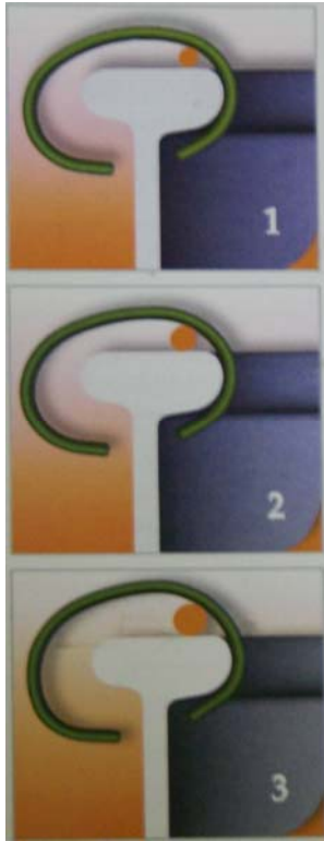
Şekil III.4. Flanş tipi kopçalarda Kopça formu-İplik geçiş aralığı ilişkisi
