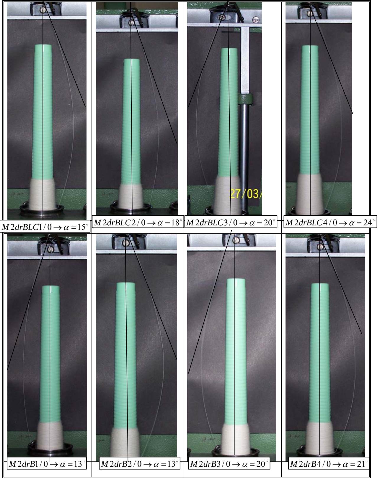
Şekil 7 M2dr tipi kopçalarla 10 000devir/dakikada üretilen Ne40 numaralı ipliklerin balon açıları.
