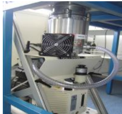
Şekil 3.22. Turbomoleküler pompa sistemi
