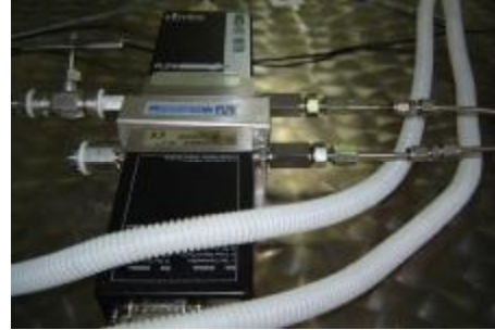
Şekil 3.25. Film üretiminde kullanılan O 2 tüpü ve Gaz Vanası
