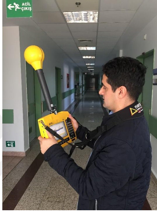
Şekil 3.7. SRM-3006 cihazı ile bant seçici ölçüm örneği
