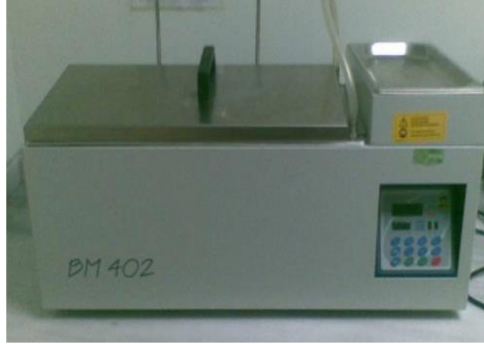
Şekil 4.8 SBF deneylerinin yapıldığı su banyosu (Kişisel arşiv, 2018)
