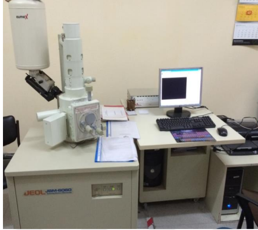
Şekil 4.6 Mikroyapı incelemelerinde kullanılan SEM/EDS cihazı (Kişisel arşiv, 2018)
