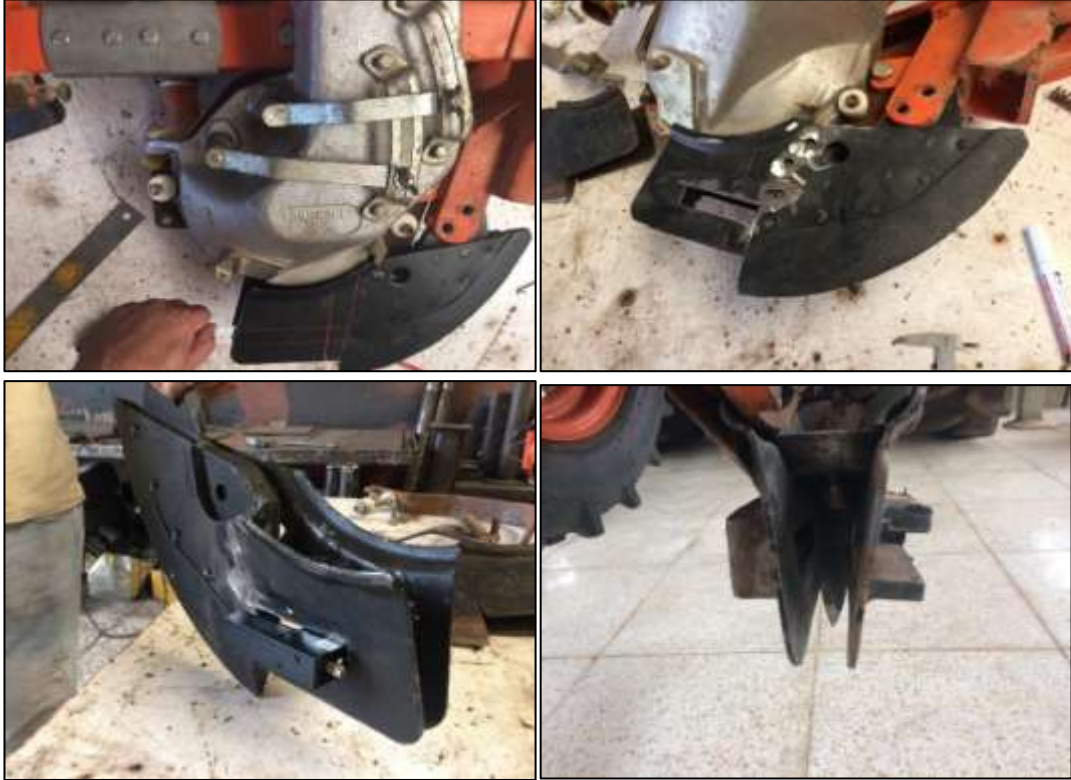
Şekil. 3.26. Balta tipi gömücü ayağa kızılötesi alan sensörün yerleştirilmesi
