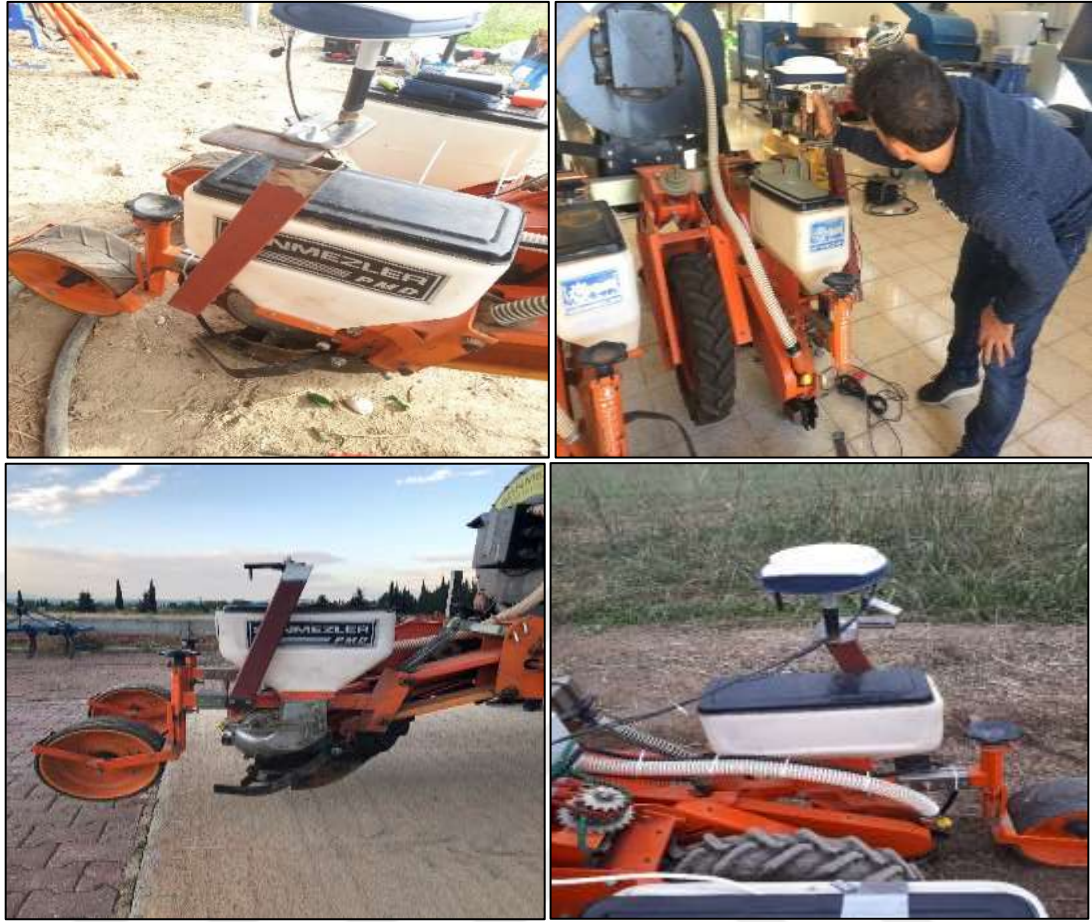
Şekil 3.11. RTK-GPS alıcısının pnömomatik hassas ekim makinasına yerleştirilmesi
