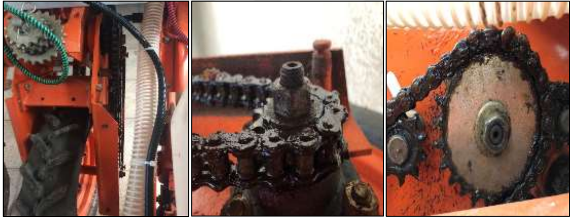
Şekil 3.16. Z_1 ve Z_2 dişlilerinin hareket iletimi
