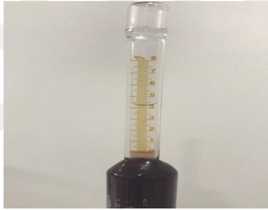
Şekil 3.2. Gerber yöntemiyle yağ tayini
