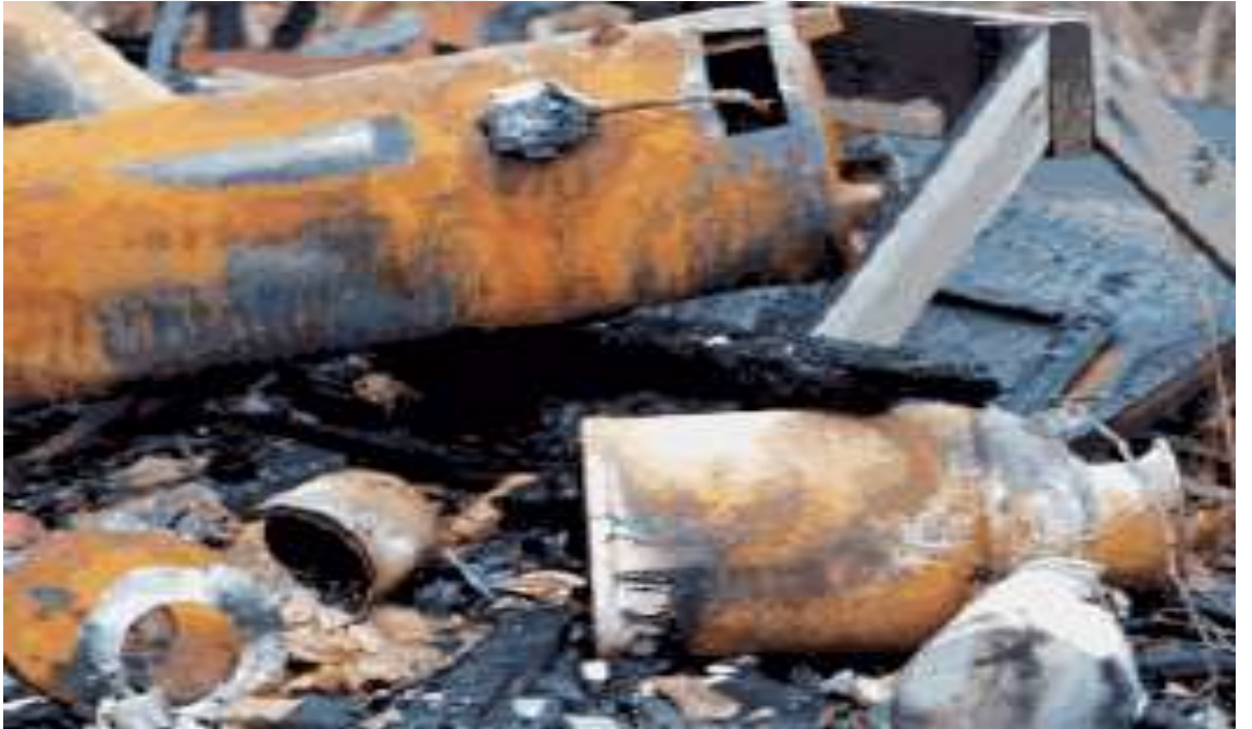
Şekil 11. Kaliforniya’da Meydana Gelen Deprem Sırasında Devrilmiş ve Yanmış Gazlı Su Isıtıcısı
