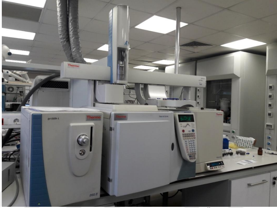
Resim 5: Kombine çalışan GC- MS, GC- FID ve Otomatik Örnekleyici Sistemi (FABAL: Ege Üniversitesi Eczacılık Fakültesi Farmasötik Bilimler Araştırma Laboratuvarı)
