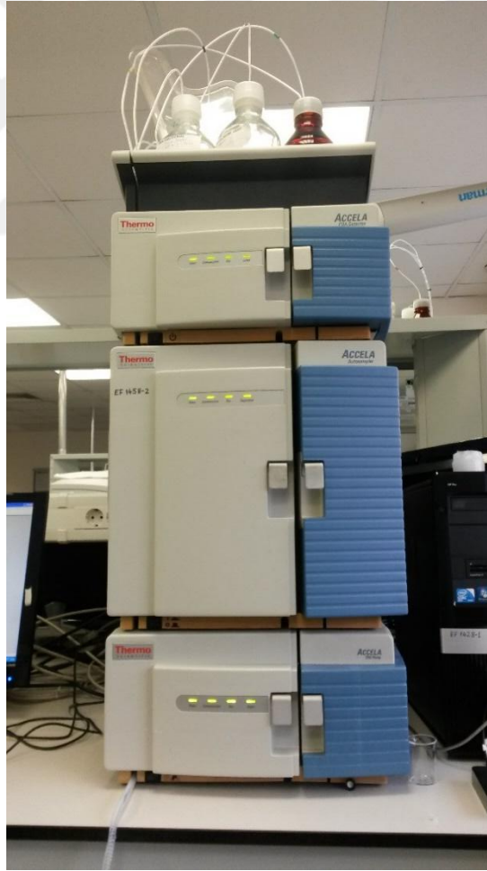
Resim 4: Yüksek Basıncılı Sıvı Kromatografisi Cihazı (FABAL: Ege Üniversitesi Eczacılık Fakültesi Farmasötik Bilimler Araştırma Laboratuvarı)
