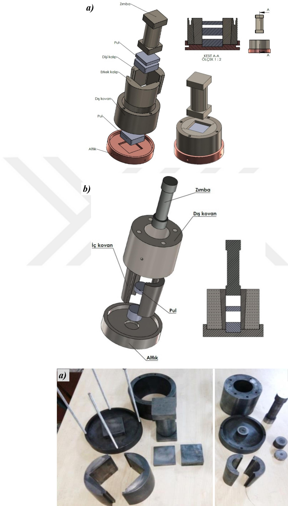
Şekil 2.21. Ayrılabilir iç kovana sahip a) kare ve b) dairesel H13 çelik kalıplar.
