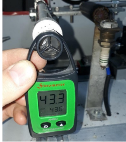
Şekil 2.37. Dairesel nozuldan hava akış hızının anemometre ile belirlenmesi.
