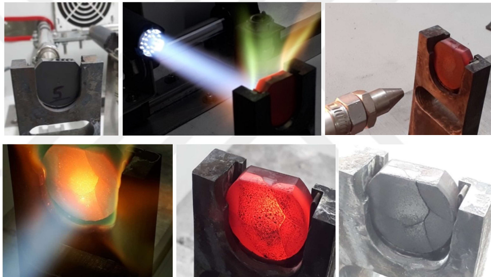
Şekil 3.105. Fe/B 4 C/0,5/1/0,1/10 FDM numuneleri termal şok deney görüntüleri.
