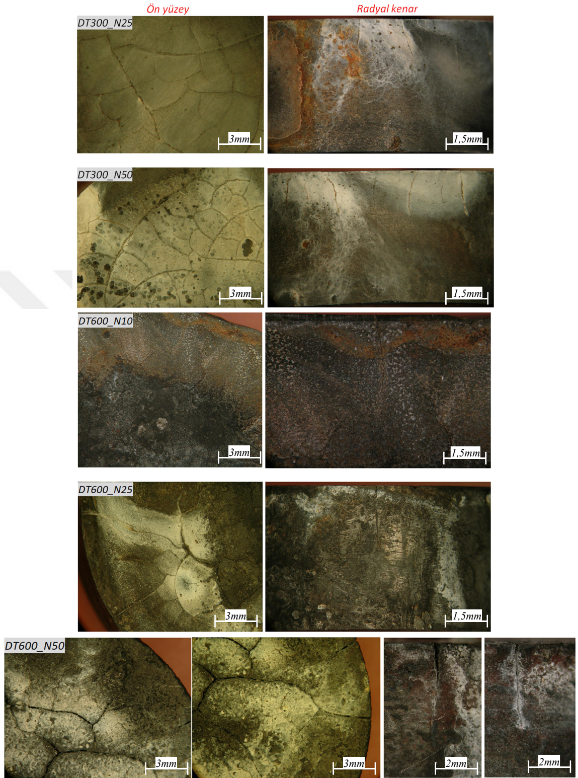
Şekil 3.118. Termal şok sonrası numunelerin ön yüzey ve radyal kenar fotoğrafları.
