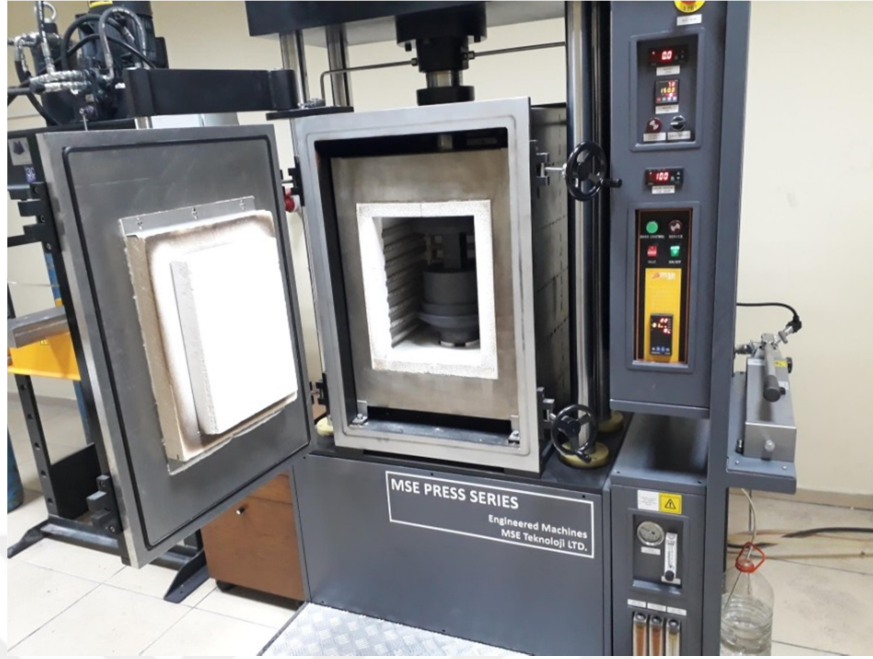
Şekil 2.23. MSE 1100-50 atmosfer kontrollü manuel sıcak pres (max 1100°C, 50 ton).
